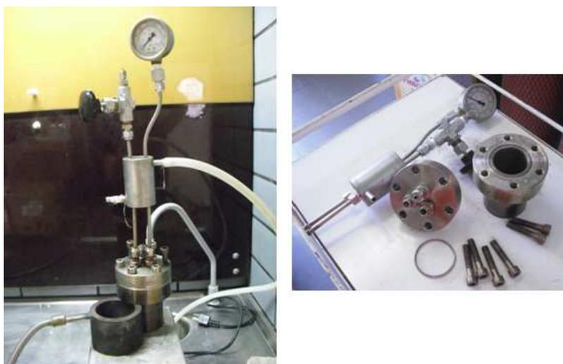
**Figura 16:** Fotos do reator de hidrocraqueamento montado e desmontado.
