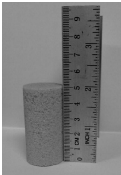
Figura 4.9 Corpo de prova de microesferas cimentadas com epóxi.
