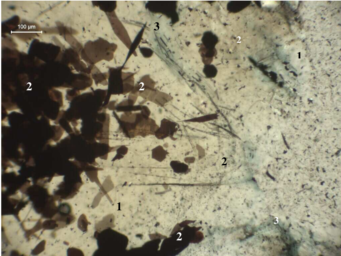
Figura 5.60 - CIII - 33: vermiculita (1) com inclusões de ilmenita (2) segundo os planos de clivagem e apresentando início de alteração para clorita (3). Polarizadores parcialmente cruzados.
