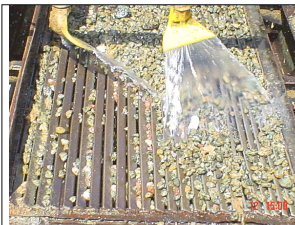
Figura 3.29 - Detalhe da grelha para separação das “pedras”.
