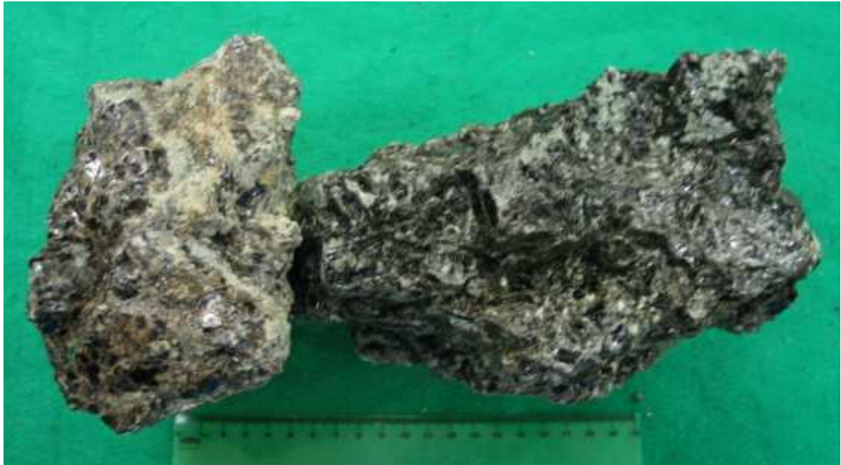
Figura 5.19 - Piroxenito hidrotermalizado mineralizado, com palhetas pegmatóides anômalas.
