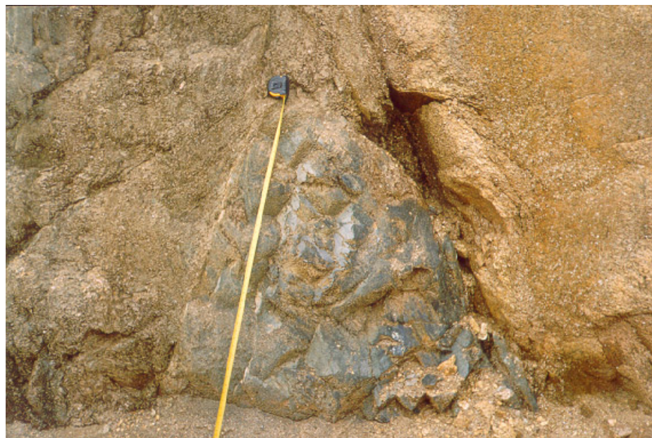
Figura 3.26 - Bloco de Peridotito hidrotermalizado não intemperizado no meio do pacote de peridotito intemperizado.
