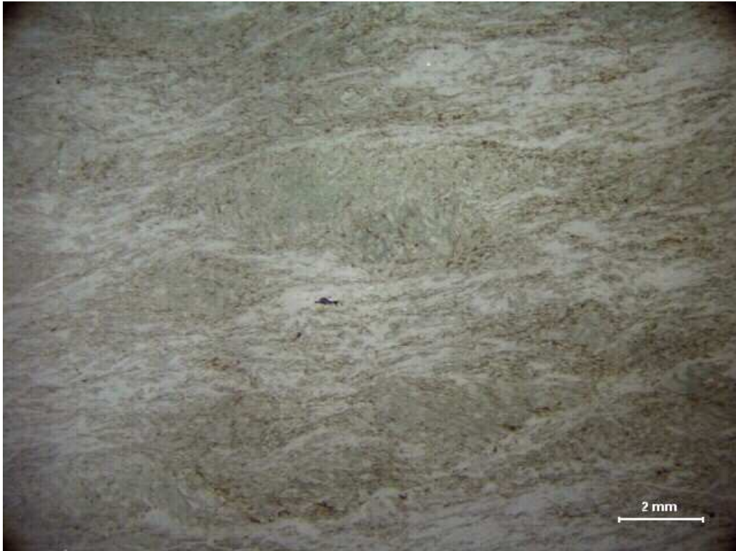
Figura 6.2 - Amostra de filonito: fotomicrografia em estereomicroscópio do “peridotito hidrotermalizado” próximo à zona de falha.
