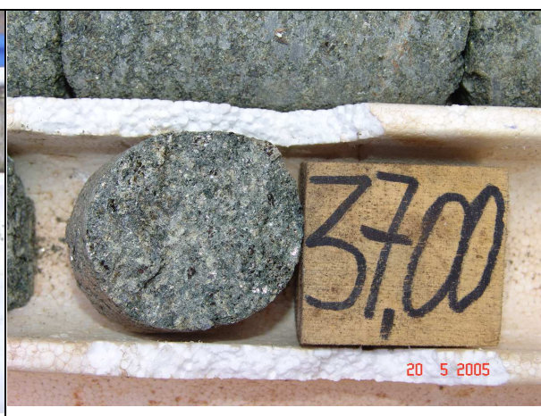
Figura 3.28 - Detalhe do final do furo SR-02, aos 37,00m (inclinado 60°), ainda mineralizado.
