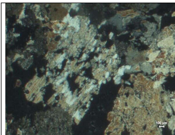
Figura 6.27 – Amostra CIII-24: mostrando piroxênio (baixa birrefringência) quase totalmente transformado em anfibólio. NX.
