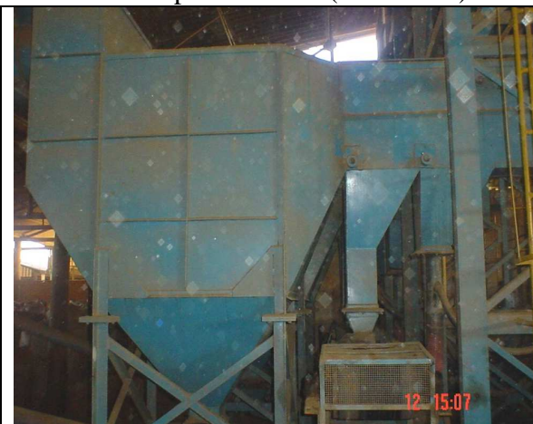
Figura 3.36 - Winnover Médio – para classificação, por tamanho, do concentrado de vermiculita crua.
