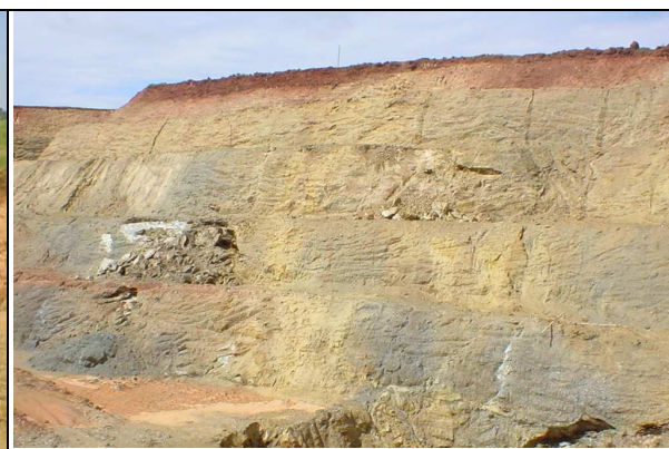
Figura 3.10 - Cava em 2003, com o perfil de intemperismo e gradação do solo para saprolito com Piroxenito hidrotermalizado alterado e porções estéreis desta rocha preservada (partes escuras).
