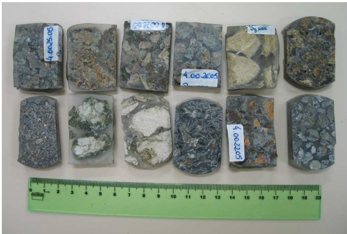
Figura 4.2 - Briquetes das contra-provas das lâminas delgadas.
