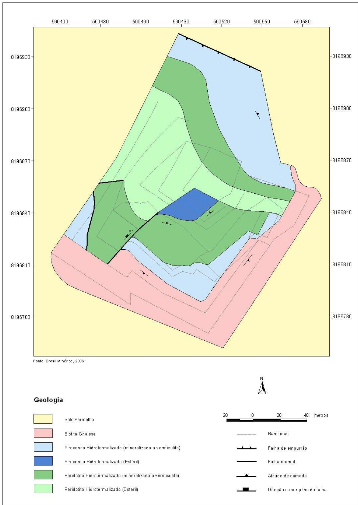
Figura 3.13 - Esboço Geológico da Cava – Porção Leste do Corpo Cerrado III.
