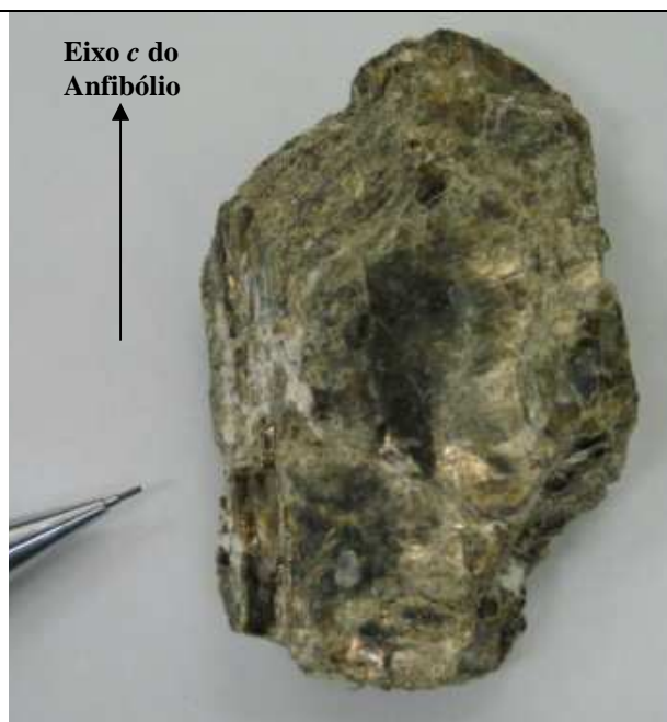
Figura 6.12 - Vermiculitas tipo “prêmio” - pseudomorfo de anfibólio com desenvolvimento da vermiculita // ao eixo c do anfibólio.
