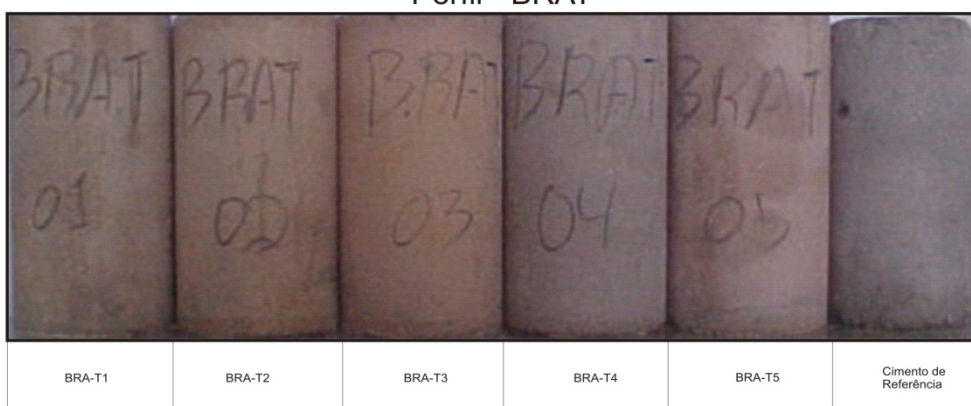
Figura A5.1 – Variação de cor entre corpos-de-prova moldados com cimento CP II-F-32 e 35% de argila calcinada. O corpo-de-prova referente a amostra BRA-C7 foi destruído.
