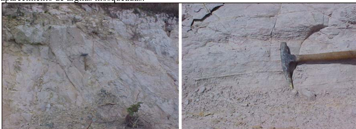
Figura VI.6 – Afloramento de metargilito cinza claro em corte de estrada no extremo oeste da mina Brazlândia (Amostra BRA-CS20).
