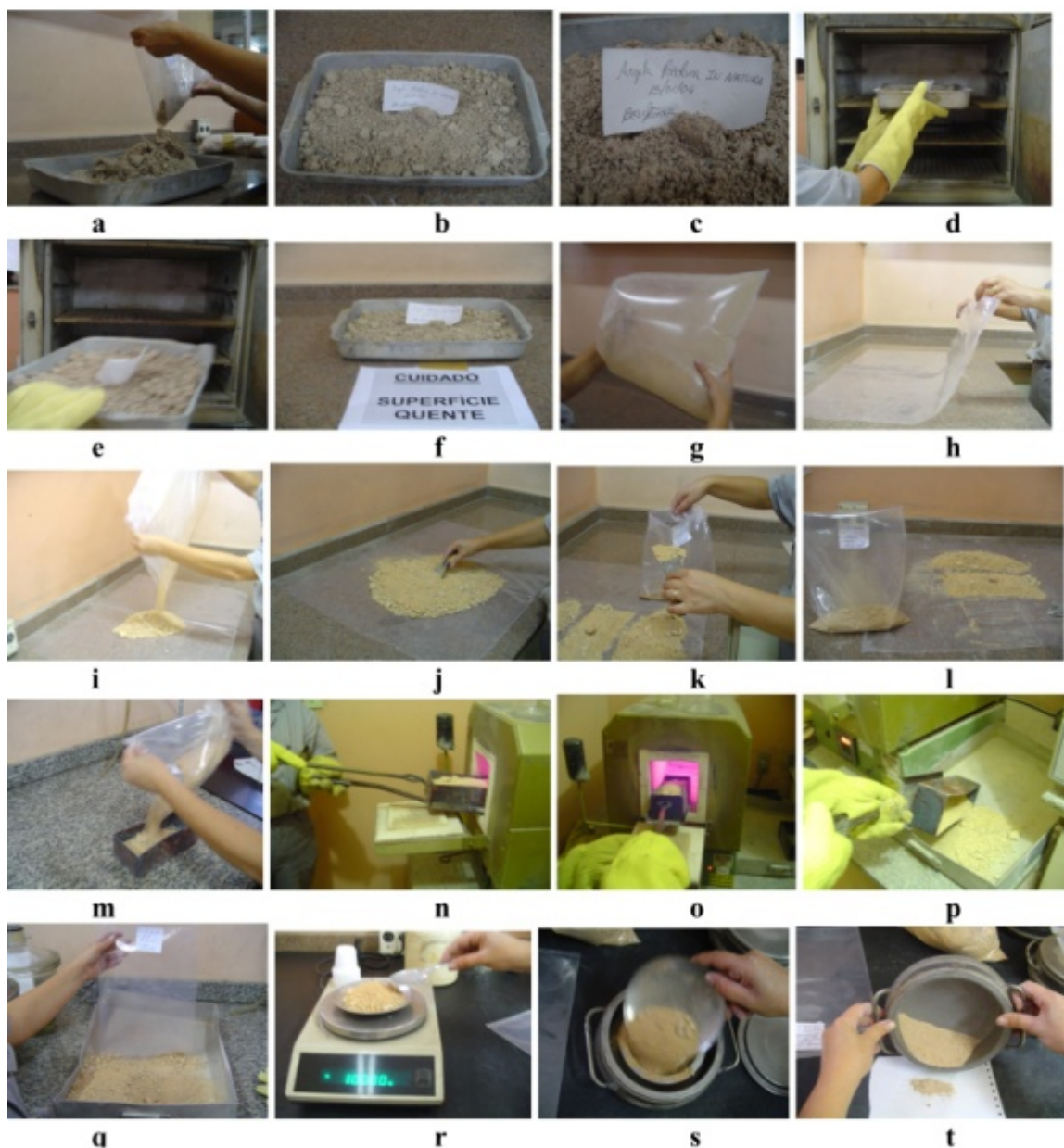
Figura V.2 - Preparação de amostras passo a passo: a b c – recebimento; d e f - secagem em estufa; g h i j – homogeneização; k l m - separação das partes; n o p – calcinação; q r s t - pesagem e moagem.
