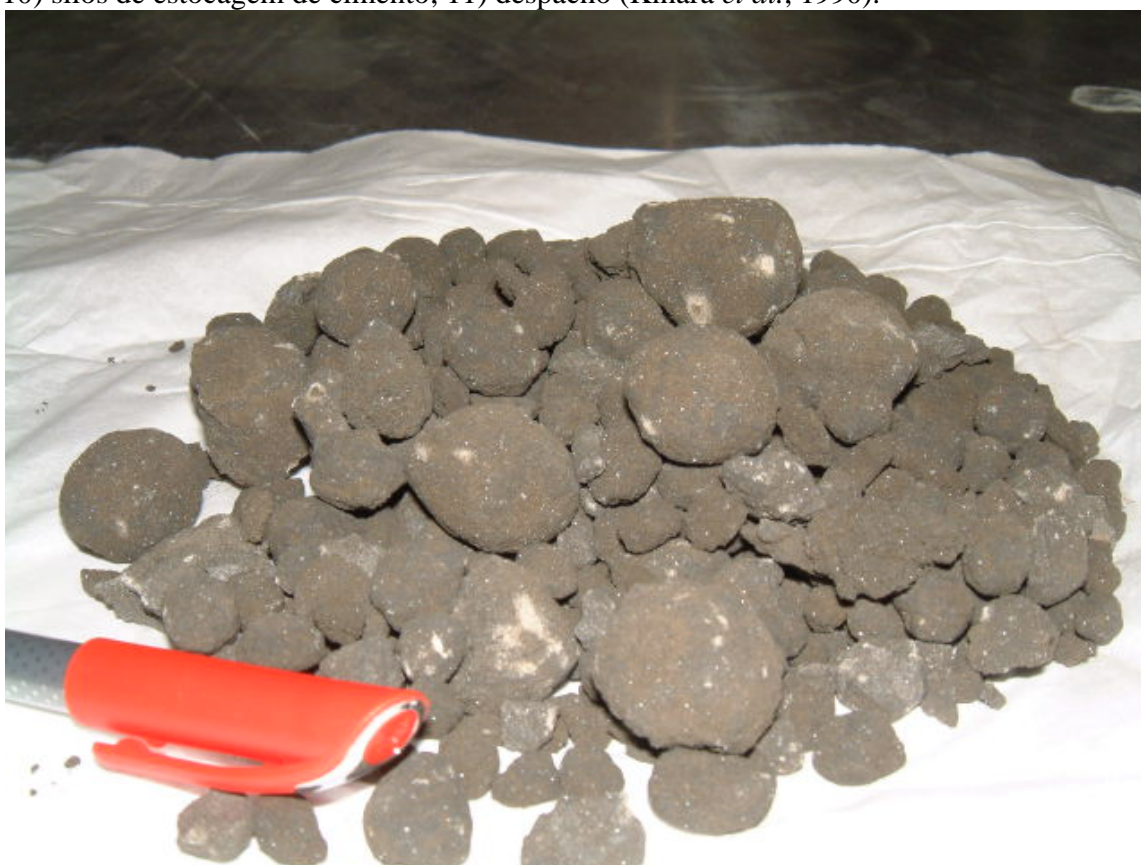
Figura II.2 – Clínquer portland obtido através da queima da farinha crua em forno rotativo a temperaturas por volta de 1450°C
