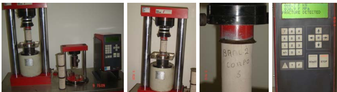
Figura V.5 – Prensa utilizada nos ensaios e sequência do processo utilizado no rompimento dos corpos-de-prova.
