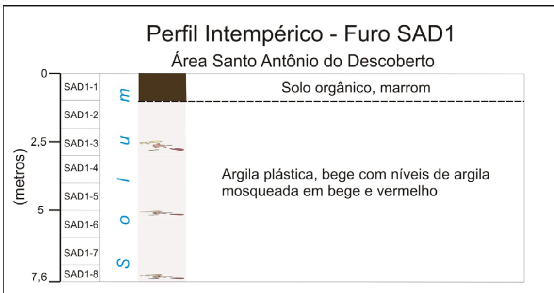
Figura VI.17 – Perfil intempérico, representando o pacote de argila utilizado como minério, obtido por furo a trado na base da área de Santo Antônio do Descoberto.
