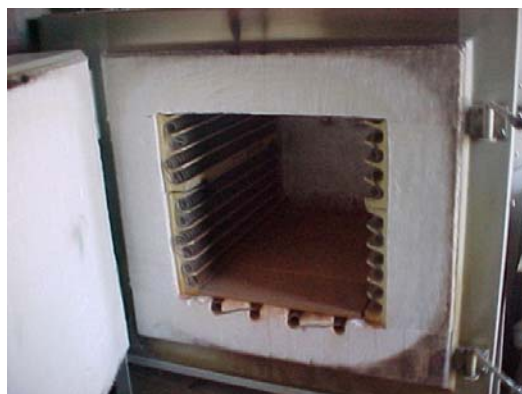
Figura V.4 – Modelo de mufla utilizada para calcinação das amostras das áreas estudadas.
