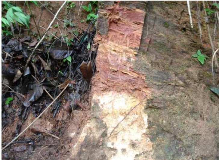
Figura 5 - Perfil de alteração em saprólito, destacando intenso cisalhamento em rocha metavulcânica da Sequência Três Palmeiras. Nota-se também o contato entre um corpo metavulcânico com rocha mais silicática.
