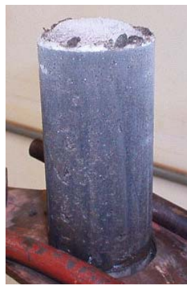
Figura 2.21 - Amostra de rejeito congelado com índice de vazios inicial de 0,818 e grau de saturação de 100% (Hernandez, 2005)
