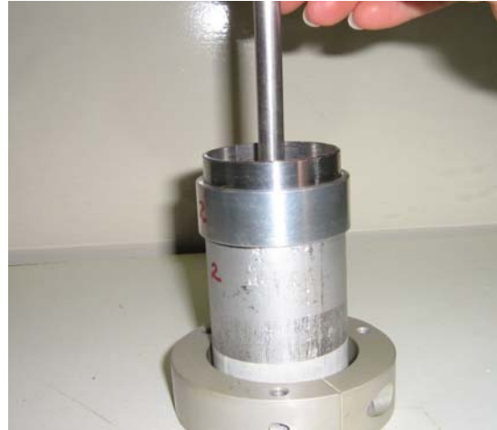
Figura 3.19 - Compactação com auxílio de haste (a) e posterior compactação com soquete (b)
