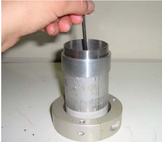
Figura 3.19 - Compactação com auxílio de haste (a) e posterior compactação com soquete (b)
