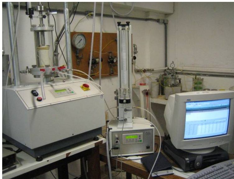
Figura 4.4 - Vista geral do equipamento triaxial com sistema automático de aquisição de dados
