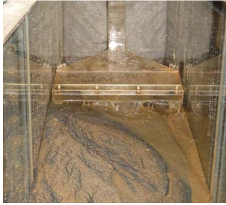
Figura 5.1 - Padrão de fluxo na superfície do aterro, com formação de ilhas mais a esquerda e processo erosivo a direita do controlador de fluxo.
