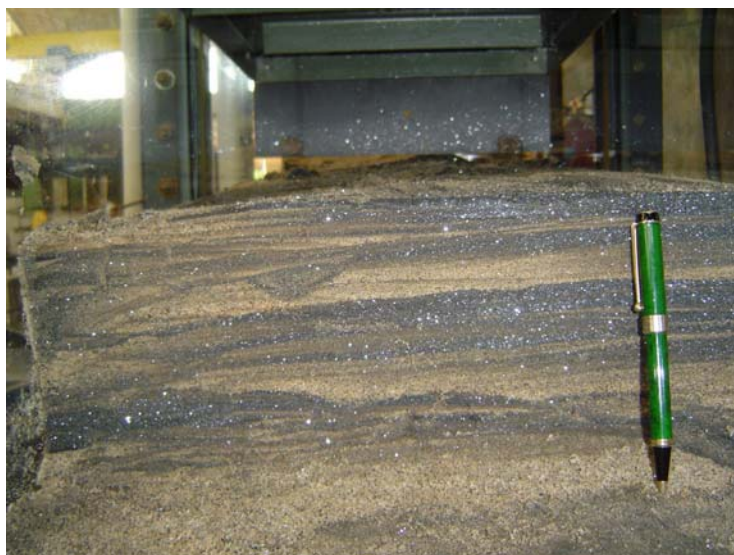
Figura 3.17 - Estratificações ocorridas na região a 2,0 m do ponto de descarga, indicando a possível variação do teor de ferro ao longo da seção transversal
