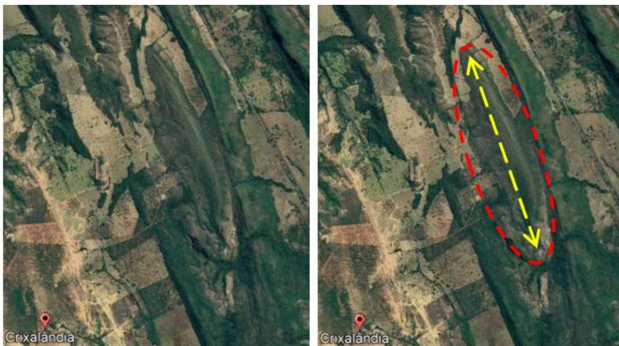
Figura 3. 6. Domo estrutural representado por dobra apertada com eixo principal N20W (destacada em vermelho) e duplo caimento de eixo (destacado em amarelo). Localizado a 2,5 km da área de estudo.
