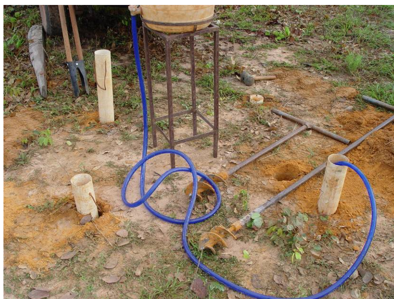
Figura 1. 4. Disposição dos tubos para o desenvolvimento de ensaio de infiltração em profundidade a partir do método open end hole . Os tubos de revestimentos dos furos a trado devem ser cravados cuidadosamente no fundo para se evitar que a água se eleve entre a parede externa do tubo de PVC e a parede do furo.
