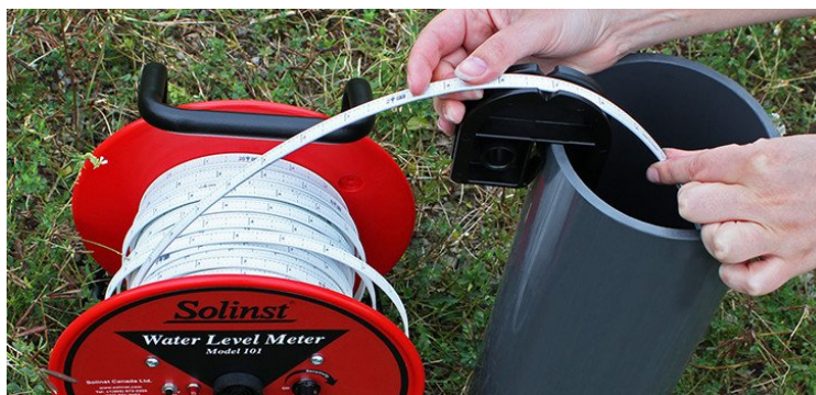
Figura 1. 2. Medidor com sensor sonoro introduzido no poço. Modelo integrado por fita de medição milimetrada.
