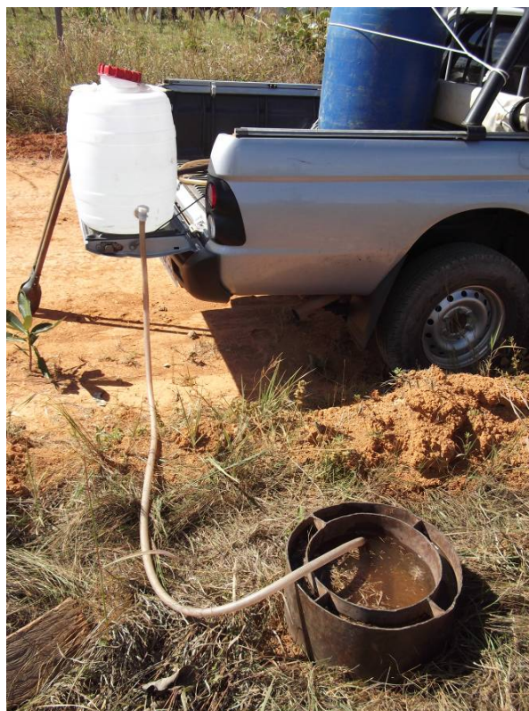
Figura 1. 3. Ensaio de infiltração em superfície de solo com aplicação da técnica do infiltrômetro de anéis concêntricos. É importante manter o nível da água do compartimento externo mais elevado para se garantir que a infiltração a partir do compartimento interno seja vertical.
