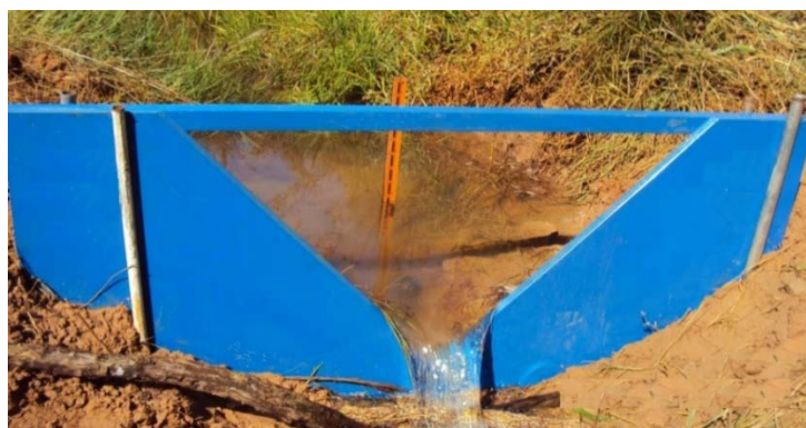
Figura 1. 5. Vertedouro triangular de Thompson. Neste sistema a vazão é proporcional à elevação da onda que se forma em virtude da reação ao barramento do fluxo.
