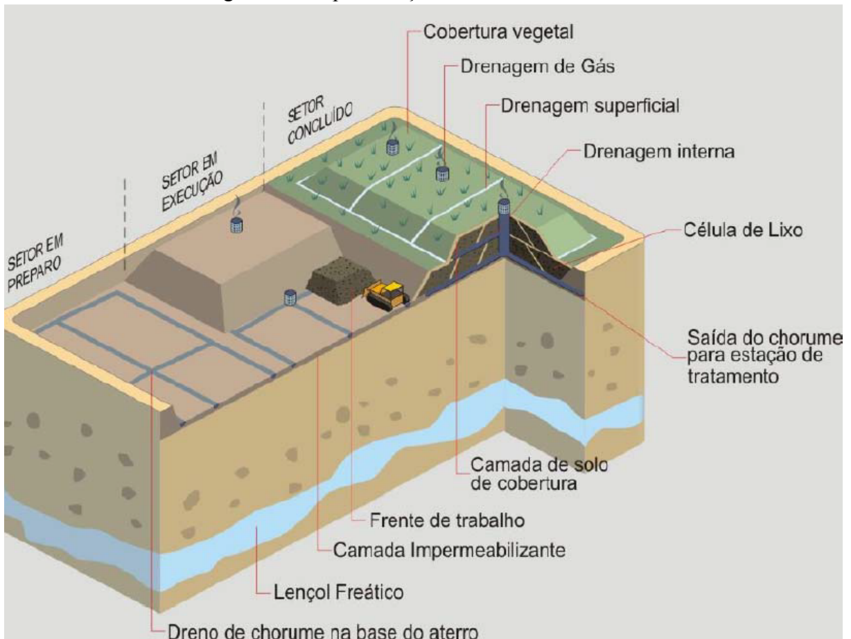
Figura 11 - Representação de um aterro sanitário
