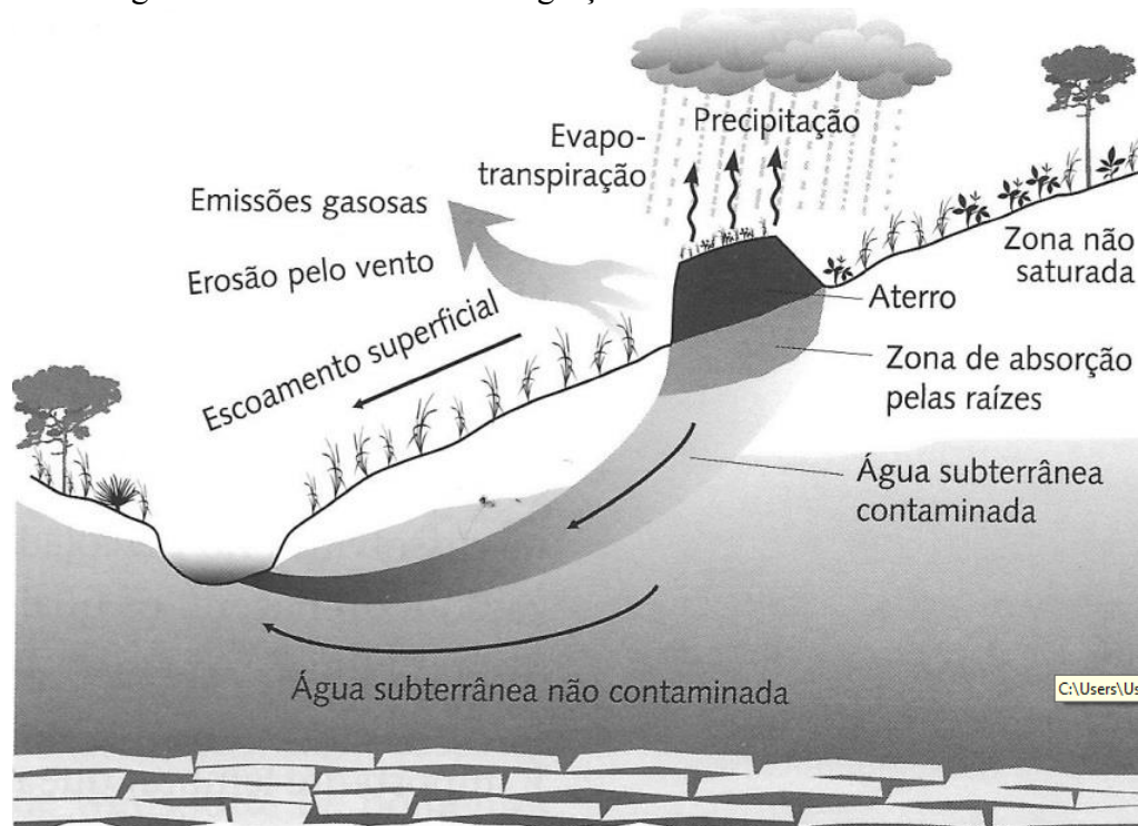
Figura 10 - Mecanismos de migração de contaminantes em aterros
