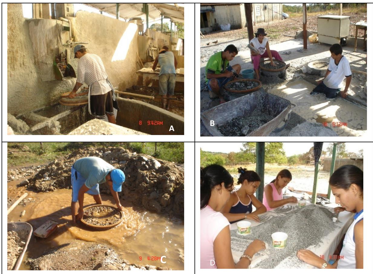
Figura 5.8 - Formas de desagregação das esmeraldas. Fig. (A) – Desagregação com batedor elétrico. Fig. (B) - Desagregação manual, Trecho do Netinho. Fig. (C) - Trecho Novo, área do Valetão: reaproveitamento da água proveniente da mina na lavagem de xisto. Fig.(D) – Trabalho feminino, seleção e cata de esmeraldas-Campos Verdes (GO). Fotos da autora (2008).
