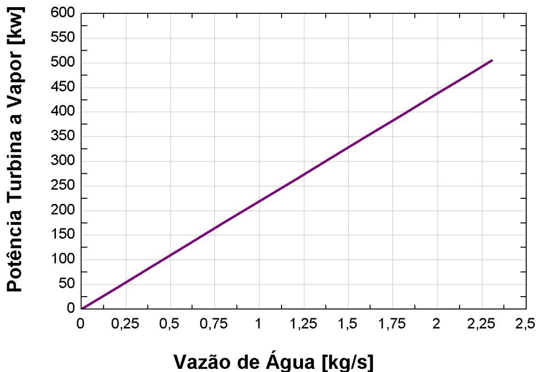
Figura 5.8: Potência gerada pela turbina a vapor em função da vazão mássica d'água Fonte: O próprio autor.
