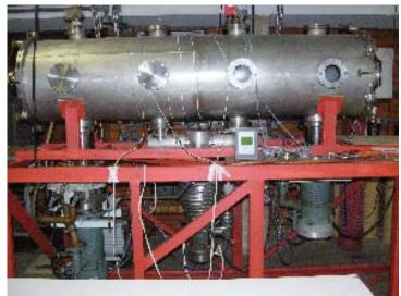
Figura 4.2: Esquema e aspecto atual do sistema de vácuo para testes do PHALL-1.
