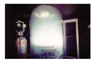
Figura 4.1: Foto do PHALL-1 em funcionamento na antiga câmara de vácuo.
