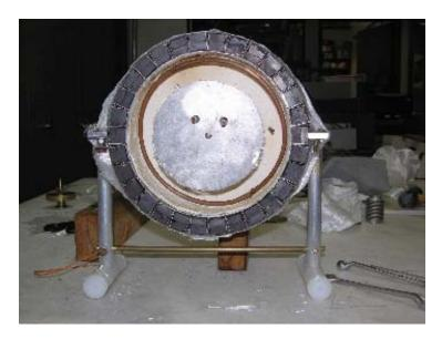
Figura 4.4: Suporte e tampão de alumínio do cilindro interior da fonte de plasma. Além dessas estruturas, vê-se na foto o tubo por onde o gás é injetado no sistema e os ímãs permanentes de ferrita utilizados no protótipo.
