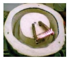
Figura 4.11: Catodo antigo em funcionamento.
