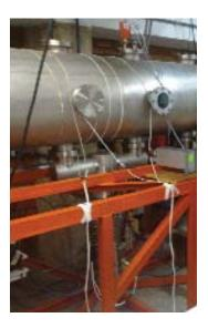
Figura 4.3: Detalhe dos medidores de vácuo na parte superior da câmara. Vemos na parte de baixo da câmara uma das três bombas difusoras instaladas.
