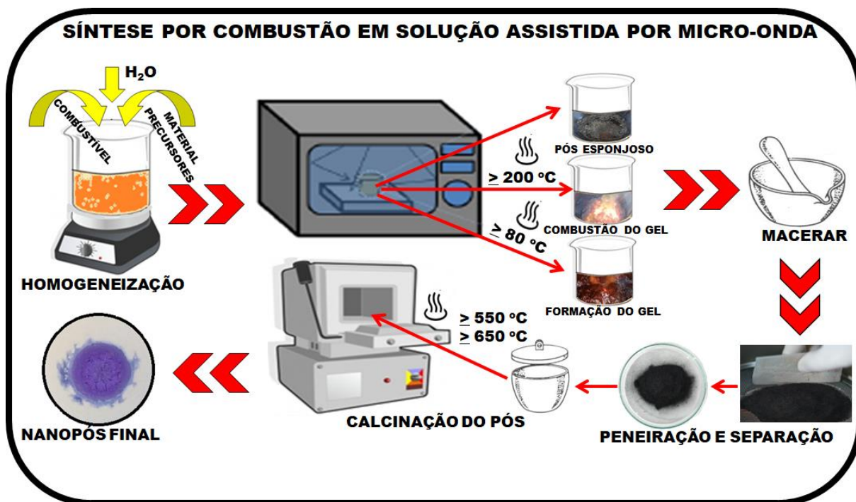
Figura 9 – Fonte do Autor. Esquemático das etapas realizadas na rota de síntese SCS assistida por micro-ondas com posterior processo de calcinação, obtendo nanoestruturas híbrida a base dos elementos \text{Co}_x\text{Si}_y\text{Te}_z .
