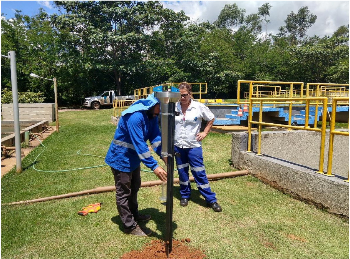
Figura 2 – Estação Pluviométrica: observador fazendo leitura do volume da precipitação
