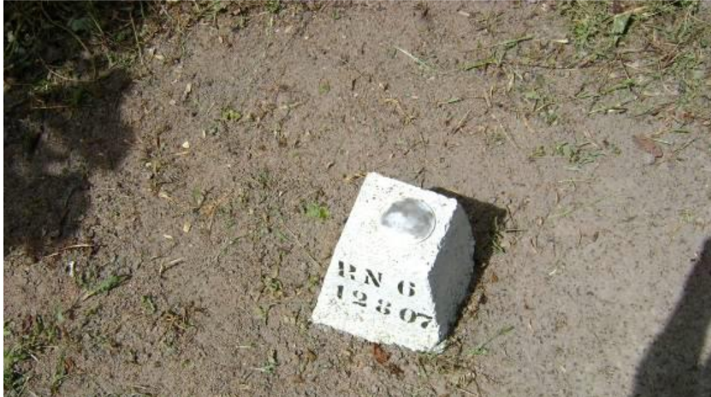
Figura 13 – Exemplo de RN instaladas segundo os padrões da ANA réguas instaladas seguindo os padrões da ANA
