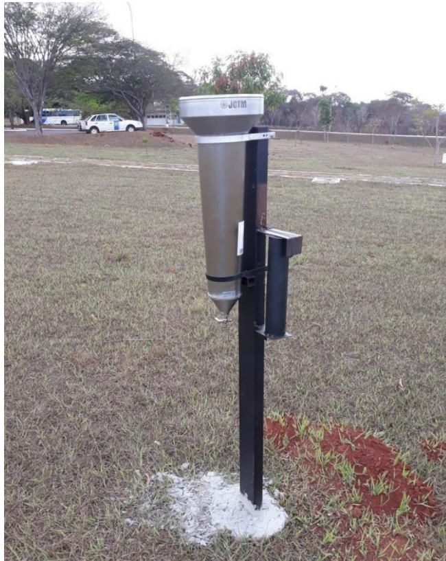
Figura 19 – Pluviômetro instalado na área da ETA Meia Ponte
