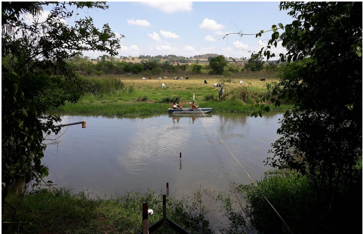
Figura 10 – Imagem da medição de vazão no ponto de controle a montante da estação fluviométrica do rio Meia Ponte
