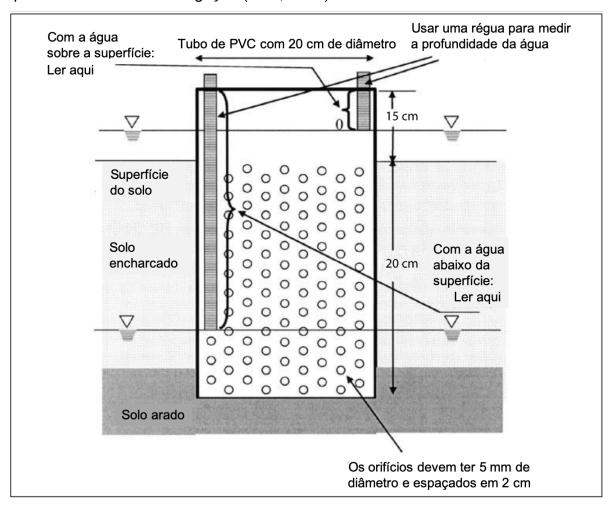
Figura 22. Ilustração do tipo de tubo utilizado para medir a profundidade da água nos campos de cultivo de arroz irrigado.
