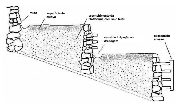
Figura 19. Esquema explicativo da construção dos terraços de montanha.
