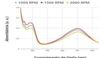
Figura 3 – Espectro de absorção do filme PVK 1:3 N2200 em diferentes velocidades de deposição.
