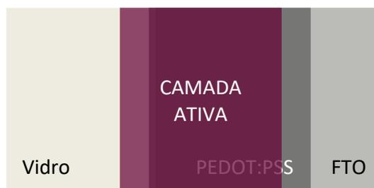
Figura 3.3 – Esquema de como delimitar a área do filme da camada ativa nos dispositivos.
