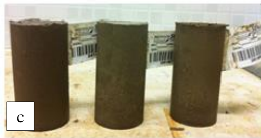
Figura F5: (a) Imagem da argamassadeira, (b) moldagem dos corpos de prova, (c) corpos de prova após a desforma.
