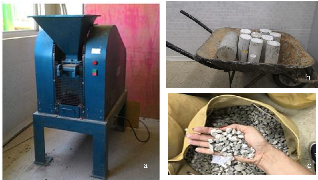
Figura 3.3 _ (a) Imagem do britador de Mandíbula, escala laboratorial, (b) Corpos de prova para britagem, (c) Material após a primeira britagem.
