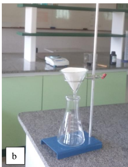
Figura F3: Ensaio de líquidos densos, para detectar teor de cloreto: (a) precipitação da amostra na capela (b) filtragem da amostra precipitada (c) material residual.
