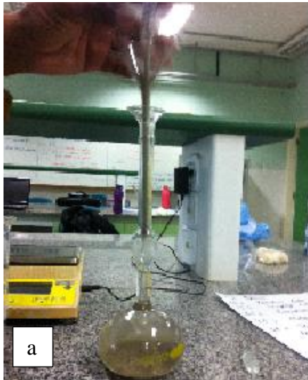
Figura F4: (a) Ensaio de massa específica pelo método de Le Chatelier, (b) detalhe do aparelho de Vicat, durante a realização do teste de início de pega em pasta de cimento.
