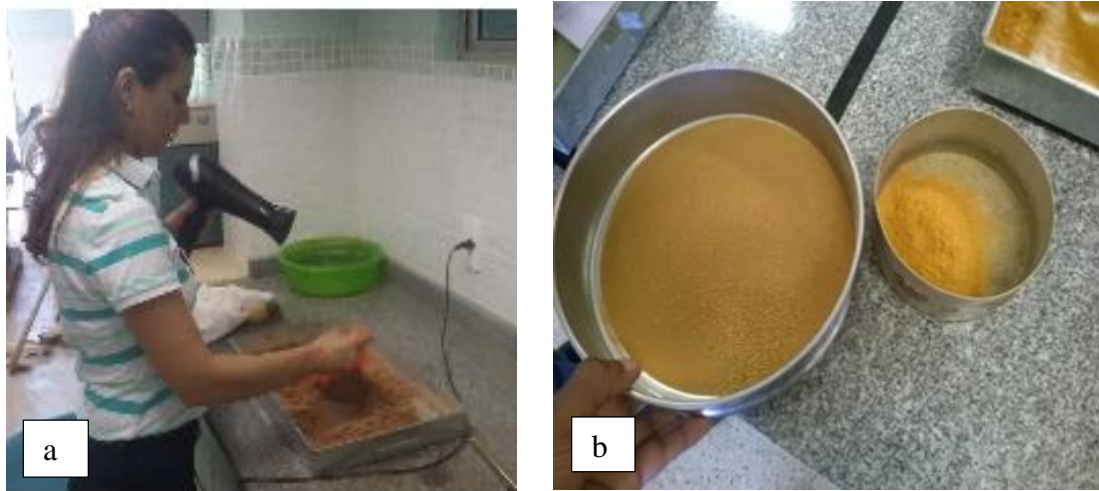
Figura F2 (a) secagem da areia para determinação das massas específicas e absorção de água, (b) separação da fração pulverulenta para realização do ensaio de massa específica.
