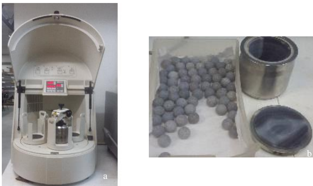
Figura 3.4 _ (a) moinho de esferas, (b) detalhe de uma das panelas e das esferas de ágata.
