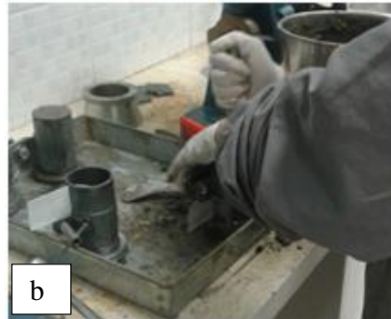
Figura F4: (a) Ensaio de massa específica pelo método de Le Chatelier, (b) detalhe do aparelho de Vicat, durante a realização do teste de início de pega em pasta de cimento.
