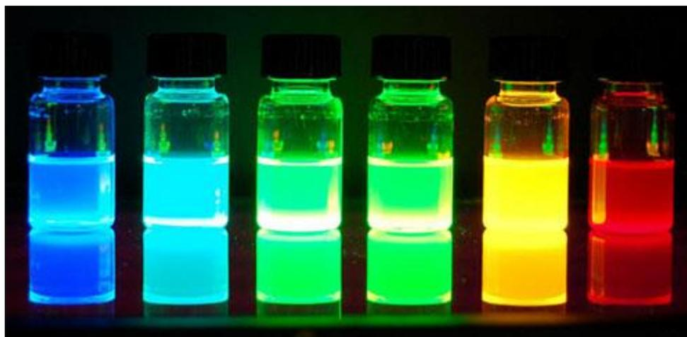
Figura 2.4. Fotoluminescência de pontos quânticos com diferentes composições de  $\text{CdS}_x\text{Se}_{1-x}/\text{ZnS}$  e com diâmetro de 6 nm. (Acessado em 14 de outubro de 2018.)
