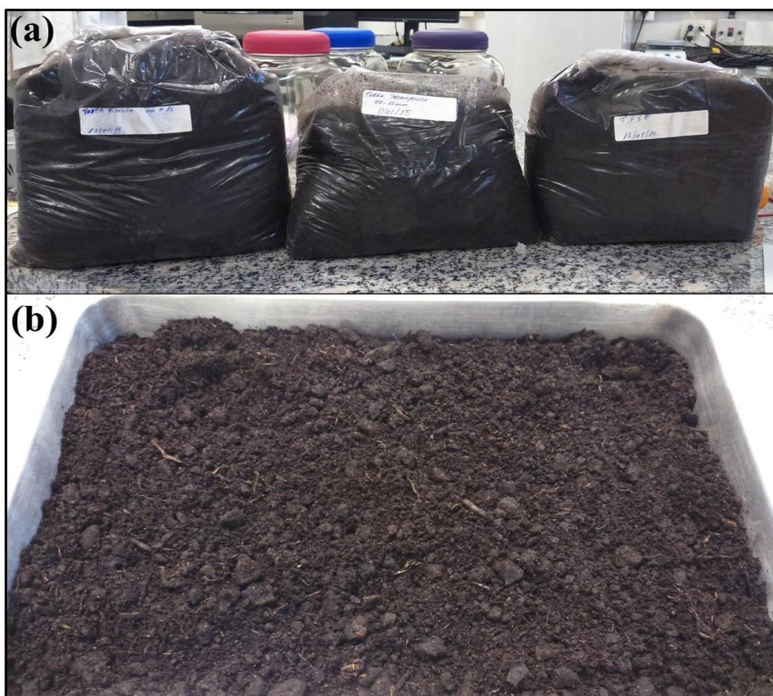
Figura 3.2. Amostras de turfa doadas pela empresa Florestal S.A. (a) Condição das amostras recebidas. (b) Uma das amostras de turfa acomodada em recipiente de alumínio para desidratação na estufa.
