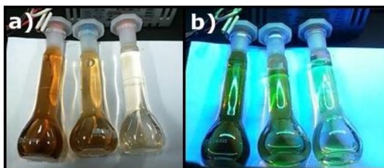
Figura 4.14. Amostras de substâncias húmicas estimuladas por luz branca fluorescente e ultravioleta. (a) *SHs* sob luz branca fluorescente. (b) *SHs* sob luz ultravioleta de comprimento de onda de 254 nm.
