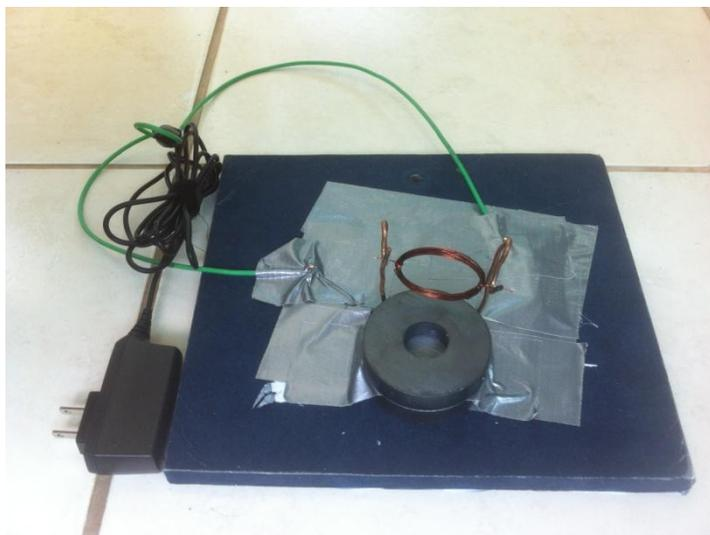
Figura 8 - Modelo da montagem do motor elétrico - imagem própria
