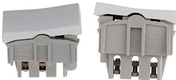
Figura 12 – Interruptor simples (dois terminais para ligação de fios) e Interruptor paralelo (três terminais para ligação de fios).
