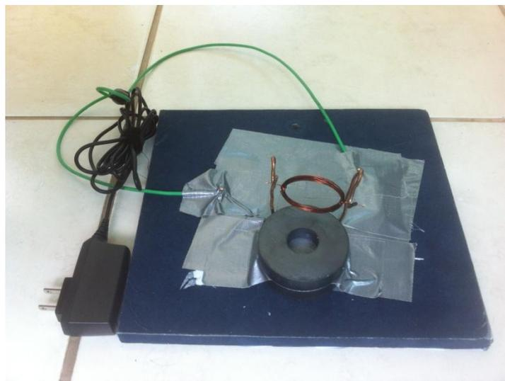
Figura 10 - Modelo da montagem do motor elétrico - imagem própria
