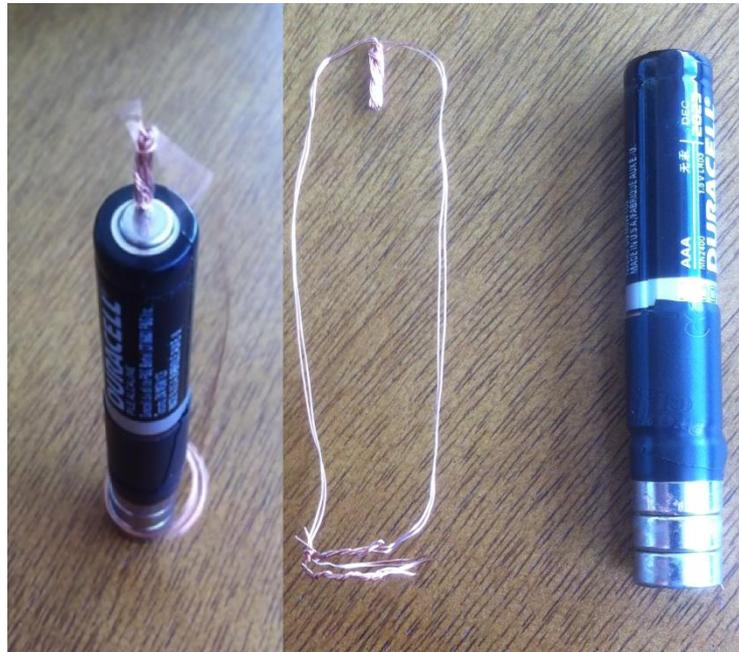
Figura 11 - - Motor elétrico simples - imagem própria
