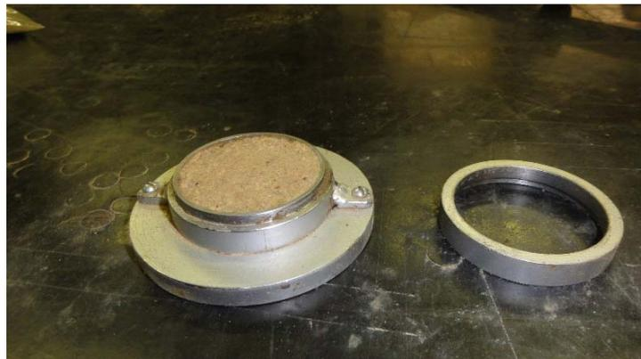
Figura 3. 11 - Molde metálico usado para compactação das amostras
