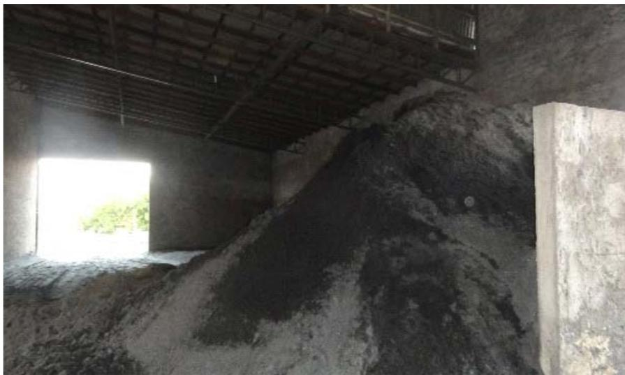
Figura 3.6 - Estocagem da cinza da casca de arroz na olaria
