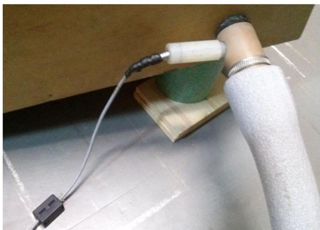
**Figura 4.8:** Posição do microfone em relação ao ângulo de incidência da onda sonora.
