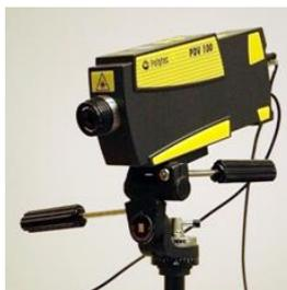
**Figura 4.9:** Vibrometro Laser (LVD).
