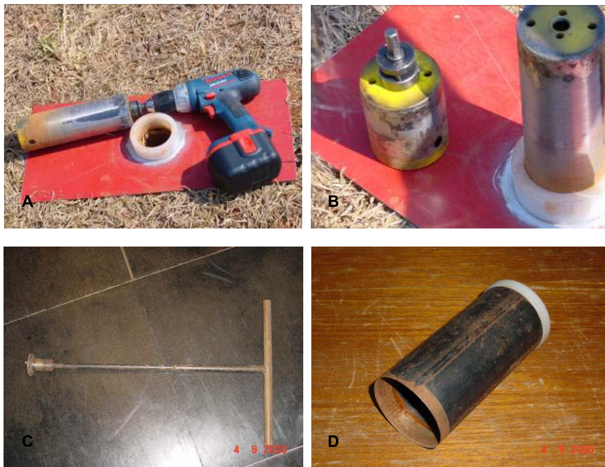
Figura 1.1. Equipamentos adaptados para coleta de amostras de solo: (A) serra-copo, furadeira e placa de apoio; (B) serra-copos adaptados para a profundidade de 0 a 5 cm e 5 a 20 cm de amostragem; (C) haste com apoio adaptado para encaixe em serra-copos; (D) cilindro para recorte de palha.
