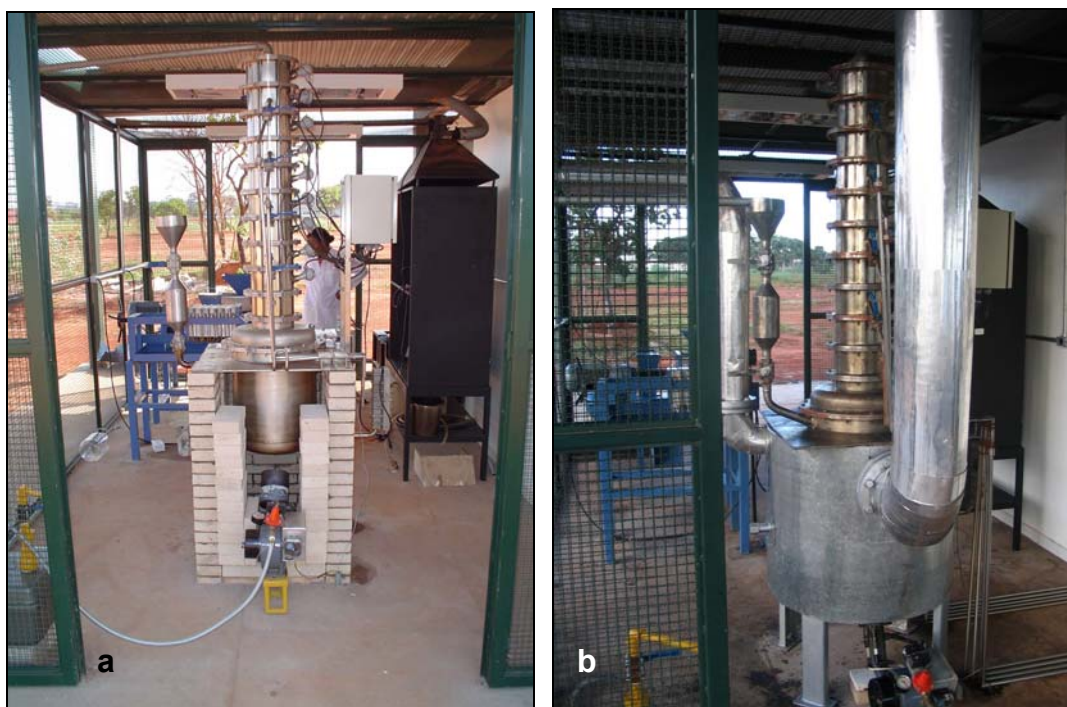
Figura 14: Forno do reator de craqueamento. (a) antes de modificações e (b) depois das modificações.
