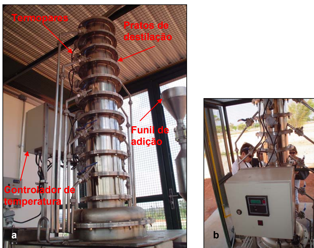
Figura 11: (a)Foto do reator de craqueamento, (b) detalhe do controlador de temperatura dos pratos.
