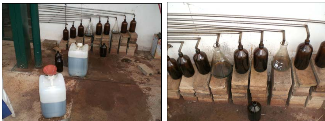
Figura 13: Sistema de coleta das frações de destilação do produto craqueado.
