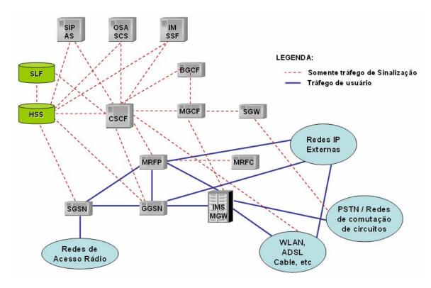
Figura 2.5 – Os elementos e as conexões da arquitetura *IMS* Fonte: Adaptado de Poikselkã (2004) e Camarillo (2006)
