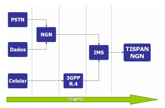
Figura 2.3 – Linha de evolução de convergência das arquiteturas *IMS* e *TISPAN NGN* Fonte: Adaptado de Brasil Telecom (2006)
