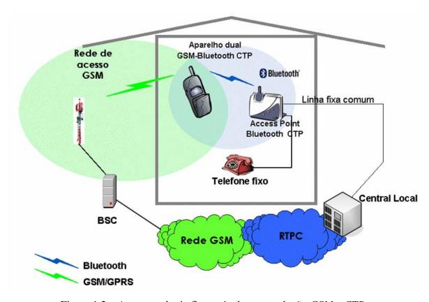
Figura 1.2 – A convergência fixo-móvel com a solução *GSM – CTP* Fonte: Adaptado de *FMCA – Fixed-Mobile Convergence Alliance* (2006)
