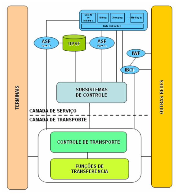
Figura 2.10 – Os componentes comuns da arquitetura TISPAN NGN Fonte: Adaptado de ETSI (2005)
