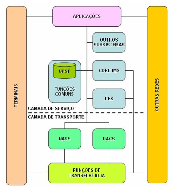
Figura 2.6 – A arquitetura *TISPAN NGN* Fonte: Adaptado de Camarillo (2006)
