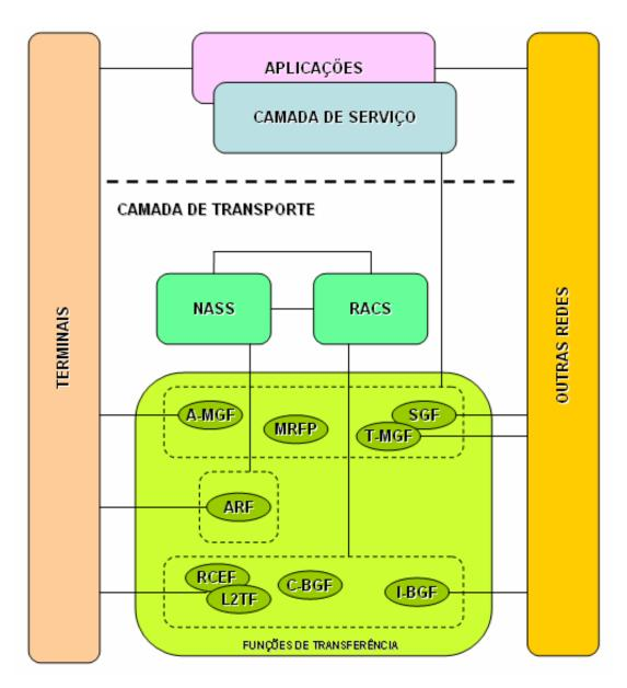
Figura 2.7 – Os elementos das funções de transferência Fonte: Adaptado de *ETSI* (2005)
