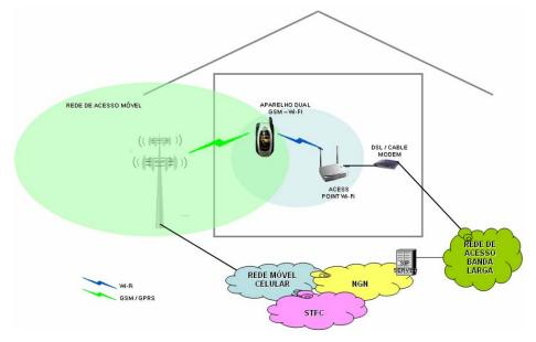
Figura 1.4 – A convergência fixo-móvel com a solução *Wi-Fi – SIP* Fonte: Adaptado de *FMCA – Fixed-Mobile Convergence Alliance* (2005b)
