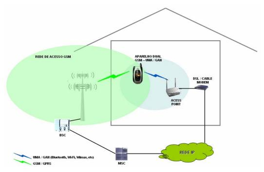
Figura 1.3 – A convergência fixo-móvel com a solução *UMA – GAN* Fonte: Adaptado de *FMCA – Fixed-Mobile Convergence Alliance* (2005a)
