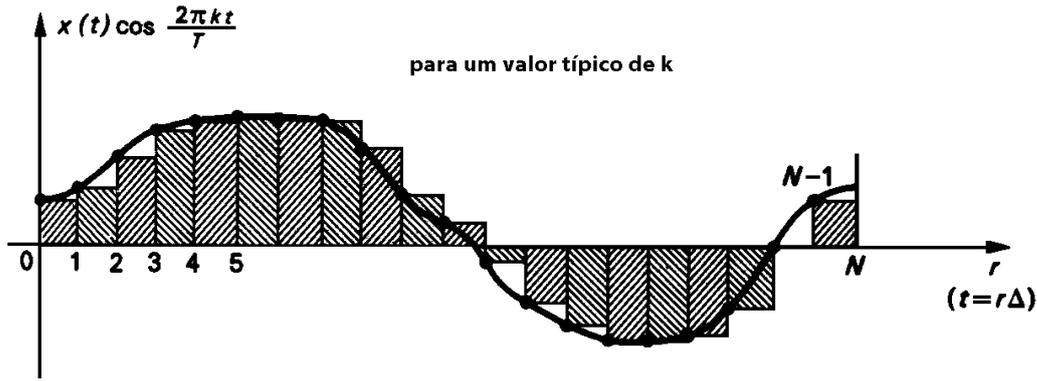
Figura C.3 - Aproximação envolvida no calculo dos coeficientes de Fourier quando considerado valores discretos
