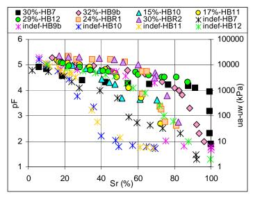
Figura 7.5 - Curvas Características Indeformadas e Compactadas dos Latossolos.
