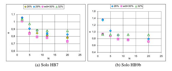
Figura 8.4 - Curvas e x N para Diferentes Umidades - Solos HB.
