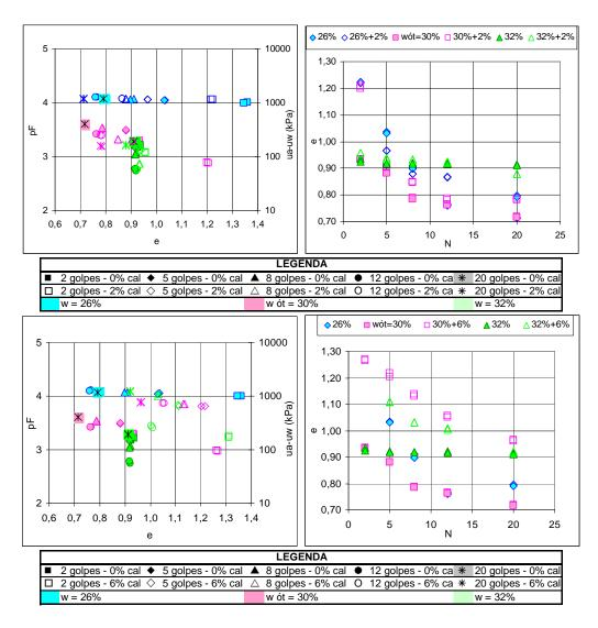
Figura IV.1 - Curvas "pF x e" e "e x N" para o solo HB9b compactado e estabilizado com diferentes teores de umidade e percentuais de cal.
