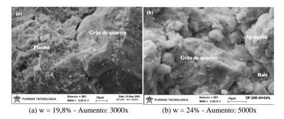
Figura 5.29 – Detalhes observados Microscopicamente para o Solo Fino (HBR1) – Rezende, (2003).
