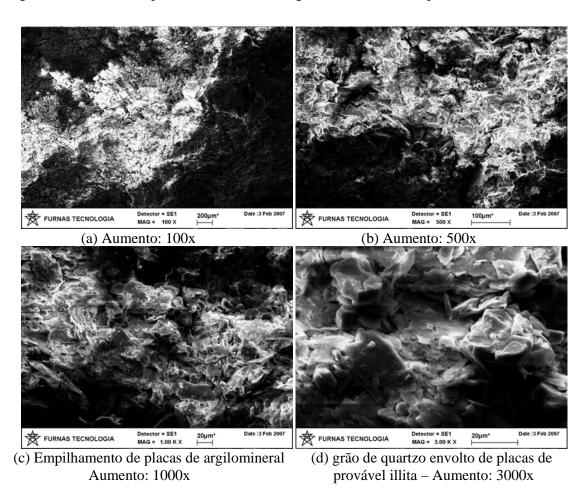
Figura 5.70 - Microscopia de Varredura do Solo SF13 Compactado na Energia PN.
