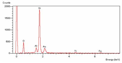
(b) Microanálise x1a - No cristal (quartzo com provável contaminação de caulinita).
