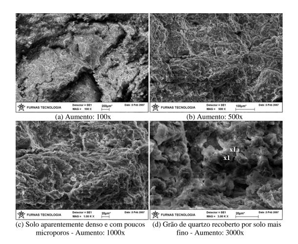
Figura 5.24 - Microscopia de Varredura do Solo HB12 Compactado na Energia PN.
