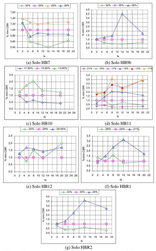
Figura 8.16 - Variação Percentual do Mini-CBR em Relação aos Valores obtidos para o Teor de Umidade de Compactação Ótimo.
