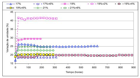
Figura 11.5 – Curva de Infiltrabilidade do Solo SF2 Natural e Estabilizado.
