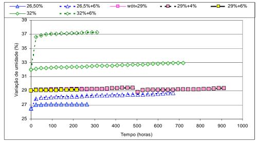
Figura XIII.3 - Evolução da umidade com o tempo para o solo HB12.
