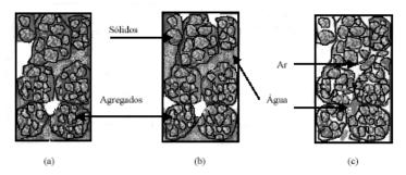
Figura 2.13 - Estruturas de Solos Compactados. a) Água contínua e ar descontínuo; b) Ar e água descontínuos e c) Ar contínuo e água descontínua (Alonso *et al.*, 1987).
