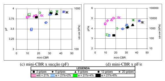
Figura 8.31 - Variação do Mini-CBR para o Solo ZM6 - Continuação.
