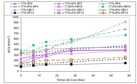
Figura XII.14 - Comparação entre os solos HB10, HB11, SF2 e SF13 compactados a 17% de umidade.
