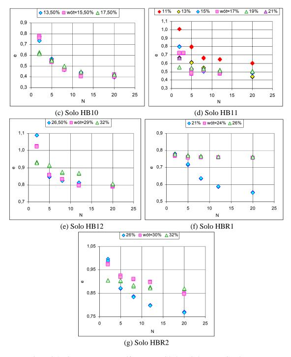
Figura 8.4 - Curvas e x N para Diferentes Umidades - Solos HB - Continuação.
