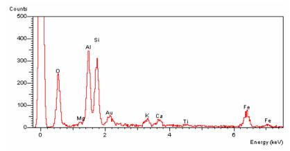
Figura 5.27 – Microanálise do Solo HB12 Estabilizado e Compactado na Energia PN – Análise realizada na massa do solo. Prováveis illita+caulinita.
