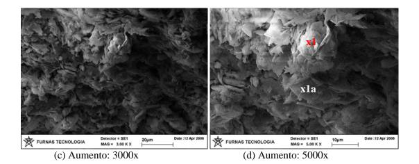
Figura 5.60 - Microscopia de Varredura do Solo SF4 Estabilizado com 6% de Cal Hidratada e Compactado na Energia PN - Continuação.
