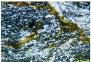
Figura 5.69 – Microscopia do Solo SF13 no Estado Indeformado, mostrando os Minerais Orientados Segundo as Foliações - Aumento: 90x. Cardoso, (2002).
