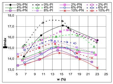
Figura II.3- Mini-compactação do solo HB10
