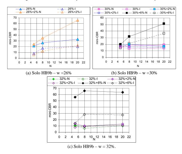
Figura 8.48 - Efeito da Saturação na Resistência do Solo HB9b.
