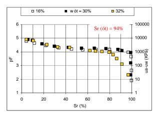
Figura 7.8 - Curvas Características do Solo HB7 Compactado em Diferentes Umidades.
