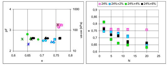
Figura III.3- Curvas "pF x e" e "e x N" para o solo HBR1 compactado no teor de umidade ótima do Proctor Normal e estabilizado com diferentes percentuais de cal.
