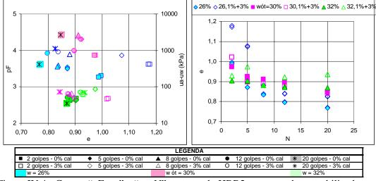
Figura IV.4 - Curvas "pF x e" e "e x N" para o solo HBR2 compactado e estabilizado com diferentes teores de umidade e percentuais de cal.
