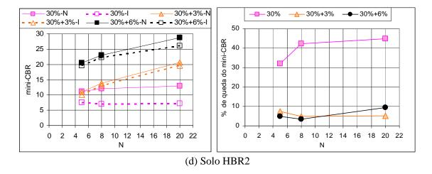
Figura VIII.1- Decréscimo de mini-CBR com a estabilização para os solos HB - Continuação.
