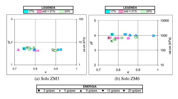
Figura 8.2 - Curvas pF x e para Diferentes Umidades - Solos ZM.
