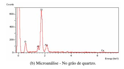
Figura 5.16 – Microanálise do Solo HB10 Estabilizado com 6% de Cal Hidratada e Compactado na Energia PN - Continuação.
