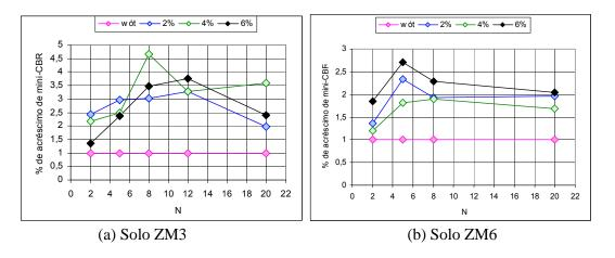
Figura 8.35 - Acréscimo (%) do Mini-CBR com a Estabilização Química – Solos ZM.
