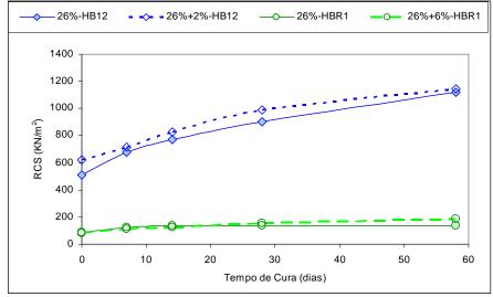
Figura XII.17 – Comparação entre os solos HBR1 e HB12 compactados a 26% de umidade.
