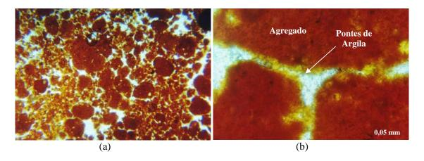
Figura 5.7 - Microscopia do Solo HB9b obtida para Amostra Natural (Indeformada).
