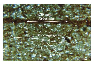
Figura 5.57 - Fotomicrografia do Solo SF4 referente à LD com Corte Perpendicular à Clivagem Ardosiana - Aumento: 90x.
