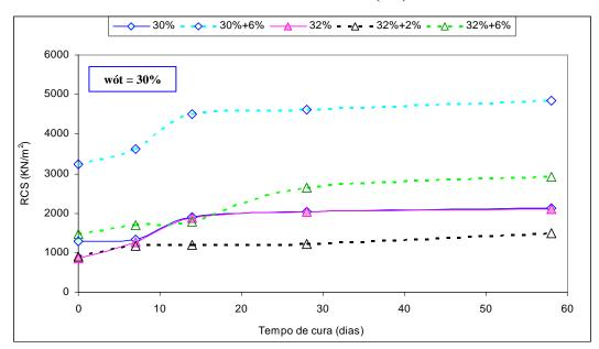
Figura 9.2 – Evolução da RCS com o Tempo de Cura para o Solo HB9b.
