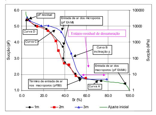
Figura 2.9 - Definição de Variáveis associadas com a Curva Característica do solo. Amostras Indeformadas – Trajetória de Umedecimento. modificado - Guimarães, (2002a).
