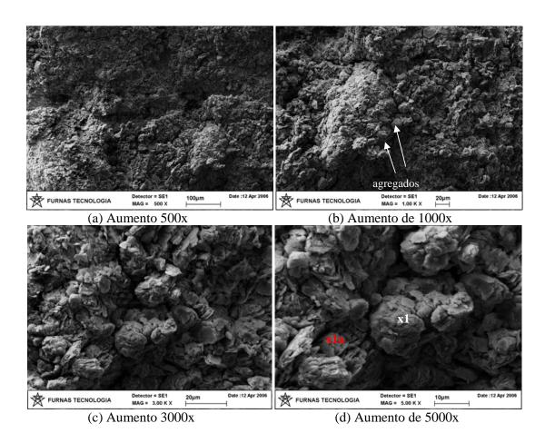
Figura 5.46 - Microscopia de Varredura do Solo ZM6 Compactado na Energia PN.
