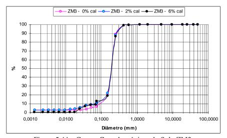
Figura 5.44 – Curvas Granulométricas do Solo ZM3.
