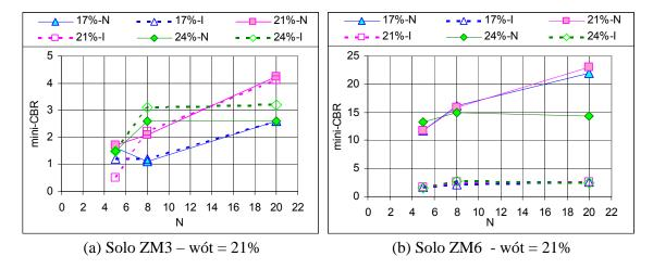
Figura 8.24 - Comparação entre os Valores de Mini-CBR Não Saturado e Saturado dos Solos pertencentes a Zona Mosqueada (ZM).
