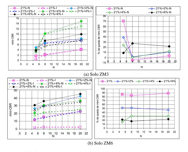
Figura 8.38 - Comparação Entre os Valores de Mini-CBR Não Saturado e Saturado dos Solos pertencentes a Zona Mosqueada (ZM).
