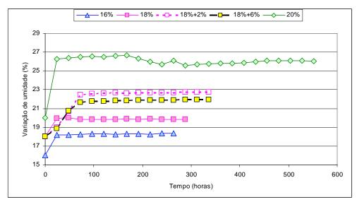
Figura XIII.7 - Evolução da umidade com o tempo para o solo SF13.
