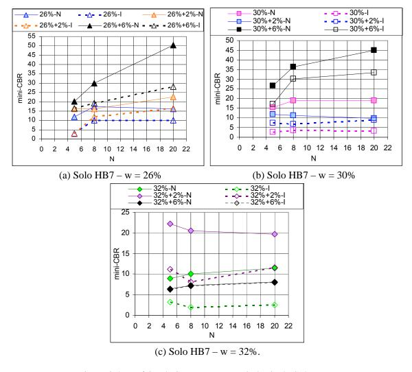
Figura 8.47 - Efeito da Saturação na Resistência do Solo HB7.
