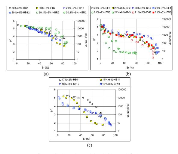
Figura 7.18 - Curvas Características de Solos Estabilizados. (Energia Proctor Normal).
