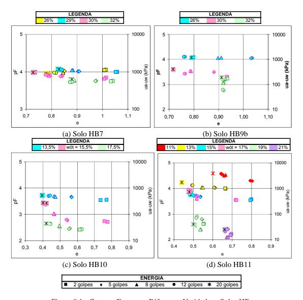
Figura 8.1 - Curvas pF x e para Diferentes Umidades - Solos HB.
