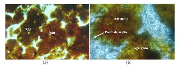
Figura 5.1 - Microscopia do Solo HB7 obtida para Amostra Natural (Indeformada).
