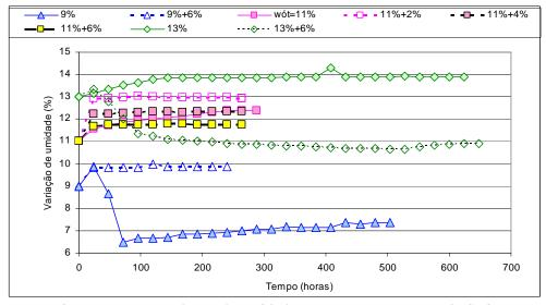
Figura XIII.6 - Evolução da umidade com o tempo para o solo SF8.
