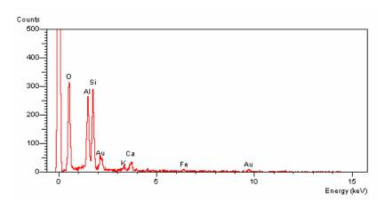
Figura 5.49 – Microanálise x1 - Na palheta. Argilomineral (prováveis ilita e caulinita). Solo ZM6 Estabilizado e Compactado na Energia PN.
