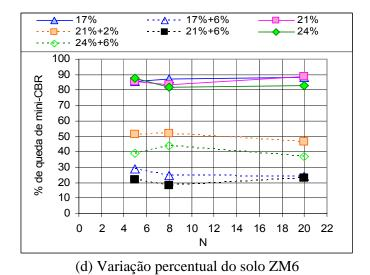
Figura 8.49 - Efeito da Saturação na Resistência do Solo ZM6 - Continuação.
