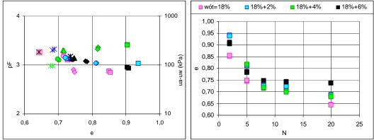
Figura III.6 - Curvas "pF x e" e "e x N" para o solo SF13 compactado no teor de umidade ótima do Proctor Normal e estabilizado com diferentes percentuais de cal.
