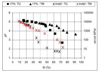
Figura 7.22 - Curvas Características do Solo HB11 na (TU) e na (TM) para wót de Compactação e Tempo de Equilíbrio de Sucção igual a 15 dias.
