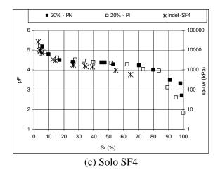
Figura 7.14 - Curvas Características Compactadas na Energia Proctor Intermediária (PI) - Continuação.
