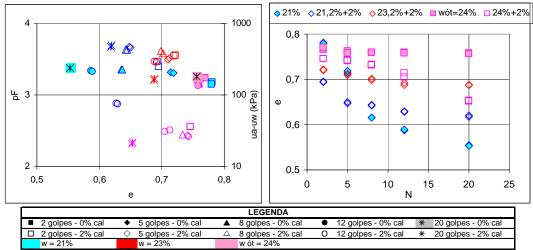
Figura IV.3 - Curvas "pF x e" e "e x N" para o solo HBR1 compactado e estabilizado com diferentes teores de umidade e percentuais de cal.
