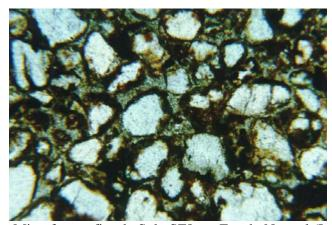
Figura 5.63 - Microfotografias do Solo SF8 em Estado Natural (Indeformado). Cardoso, (2002).
