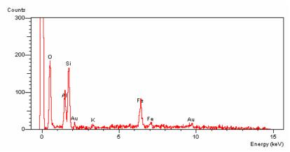
(c) Microanálise x1c - Na placa na massa pulverulenta. Argilomineral (provável ilita e/ou caulinita).
