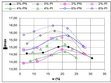
Figura II.7- Mini-compactação do solo ZM6
