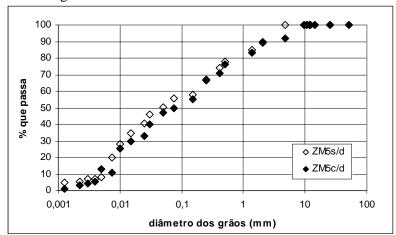
Figura I.9 – Curvas Granulométricas do solo ZM5.
