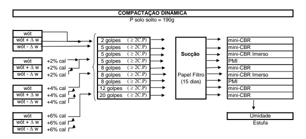
Figura 3.8 – Obtenção dos Valores de Mini-CBR e PMI
