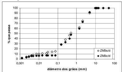
Figura I.8 – Curvas Granulométricas do solo ZM3.
