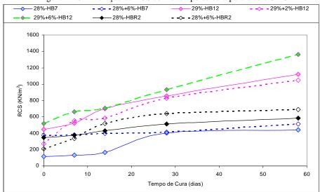
Figura XII.10 – Comparação entre os latossolos compactados a 28% e 29% de umidade.
