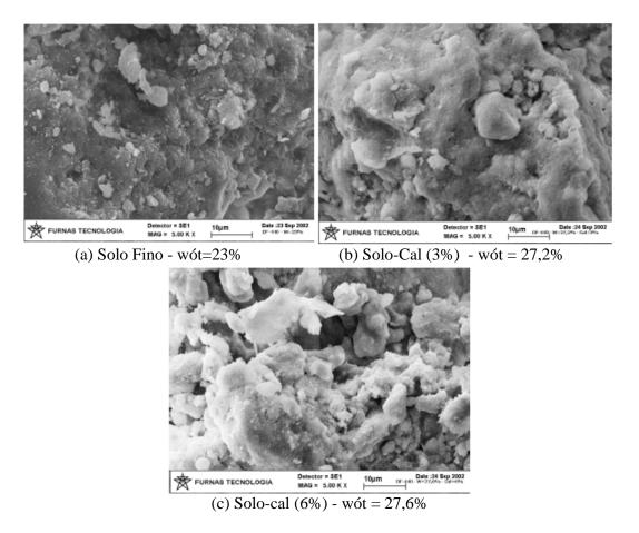
Figura 5.37 – Microscopia de Varredura – Materiais Diversos – Aumento de 5000x Rezende, (2003)
