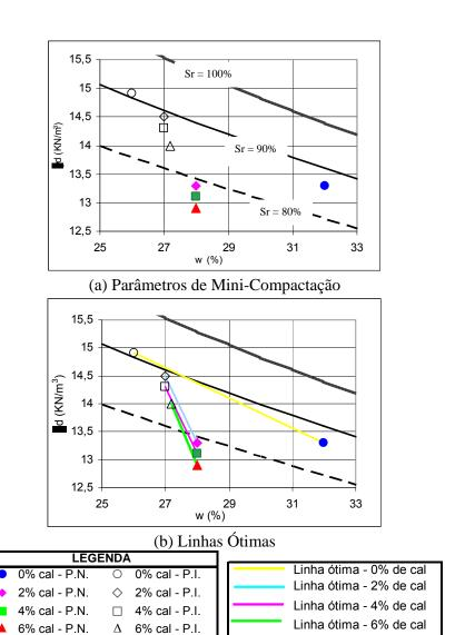
Figura 6.3 – Mini-Compactação do Solo HB9b.
