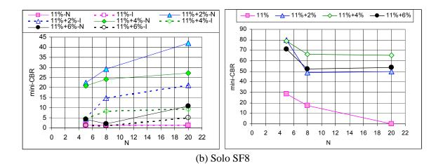
Figura 8.39 - Comparação Entre os Valores de Mini-CBR Não Saturado e Saturado dos Solos Saprolíticos Finos (SF) - Continuação.
