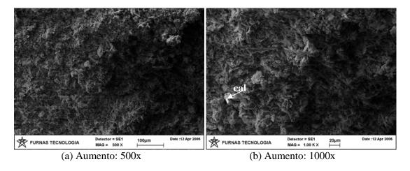
Figura 5.60 - Microscopia de Varredura do Solo SF4 Estabilizado com 6% de Cal Hidratada e Compactado na Energia PN.
