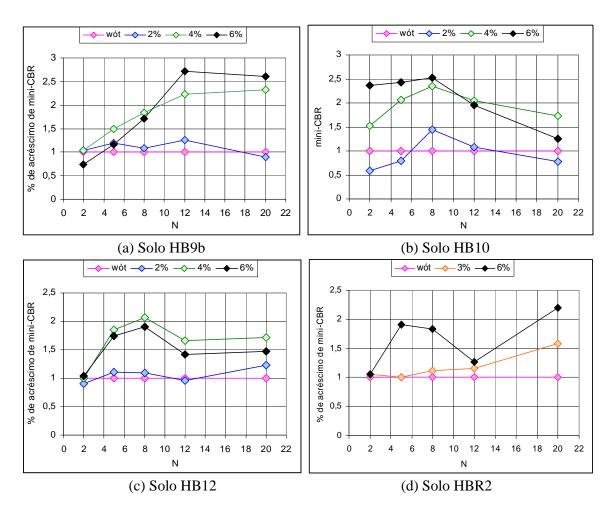
Figura VII.1- Acréscimo de Mini-CBR com a estabilização para os solos HB.
