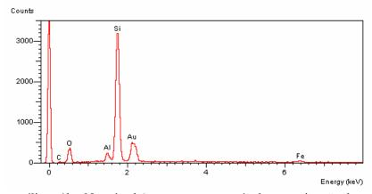
(c) Microanálise x1b - No cristal (quartzo com provável contaminação de caulinita).
