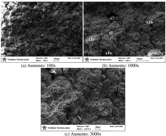
Figura 5.21 - Microscopia de Varredura do solo HB11 Estabilizado e Compactado na Energia PN.
