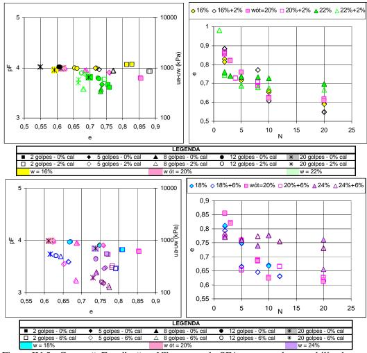
Figura IV.5 - Curvas "pF x e" e "e x N" para o solo SF4 compactado e estabilizado com diferentes teores de umidade e percentuais de cal.
