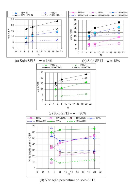
Figura XI.7 - Efeito da saturação na resistência do solo SF13.
