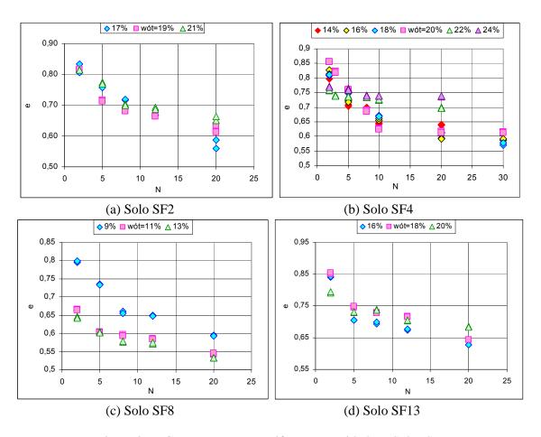
Figura 8.6 - Curvas e x N para Diferentes Umidades - Solos SF.
