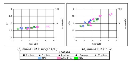
Figura V.5 - Variação do Mini-CBR para o solo ZM3 - Continuação.
