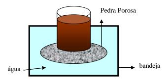
Figura 3.9 – Ensaio de Absorção.
