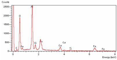
(a) Microanálise x1 - Na massa (provável caulinita) com carbonato e cimento de óxido/hidróxido ferro e/ou titânio.
