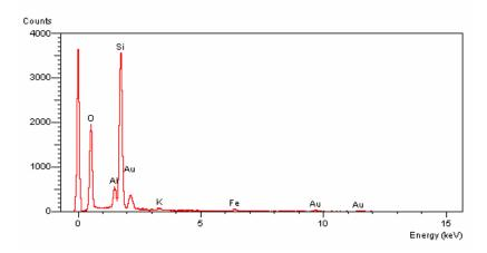
(a) Microanálise x1 - No cristal de quartzo (com provável contaminação de illita).
