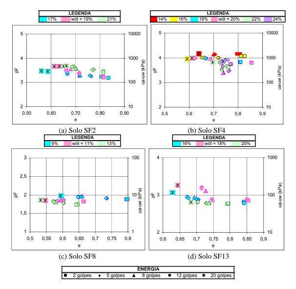
Figura 8.3 - Curvas pF x e para Diferentes Umidades - Solos SF.
