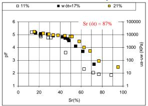
Figura 7.10 - Curvas Características do Solo HB11 Compactado em Diferentes Umidades.
