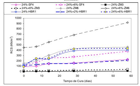
Figura XII.16 – Comparação entre os solos HBR1, ZM3, ZM6 e SF4 compactados a 24% de umidade.
