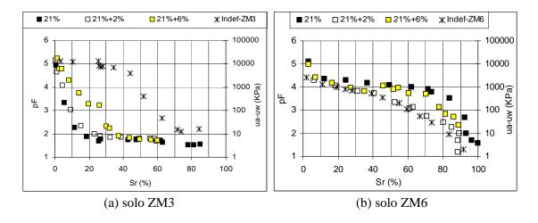
Figura 7.16 - Curvas Características dos Solos pertencentes à Zona Mosqueada Estabilizados Quimicamente. (Energia Proctor Normal - PN)
