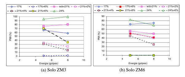
Figura 10.2 – PMI Obtidas para os Solos da Zona Mosqueada Com e Sem Estabilização Química.
