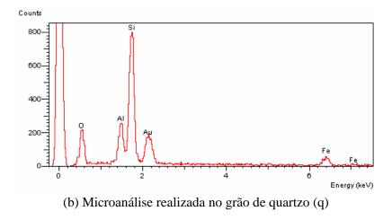
Figura 5.3 - Microanálise do Solo HB7 Compactado na Energia PN - Continuação.
