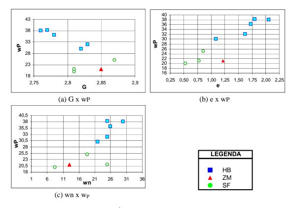
Figura 4.1 - Índices Físicos x Limite de Plasticidade
