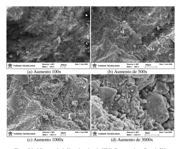
Figura 5.8 - Microscopia de Varredura do solo HB9b Compactado na Energia PN.
