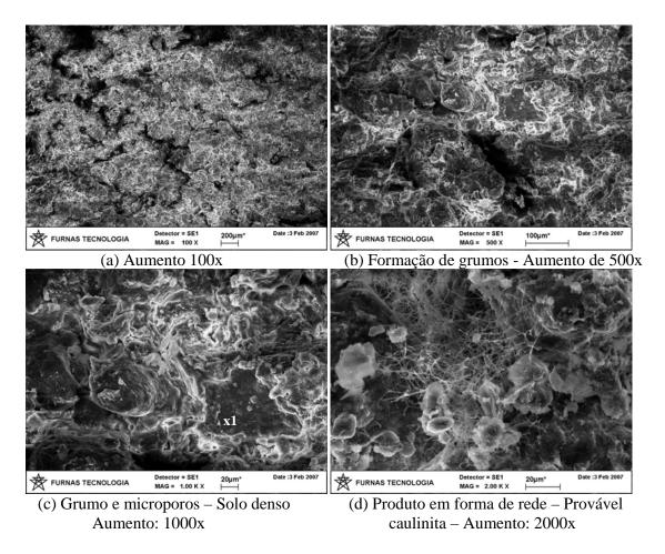
Figura 5.13 - Microscopia de Varredura do Solo HB10 Compactado na Energia PN.
