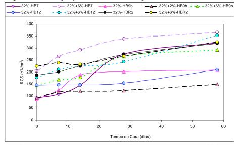
Figura XII.11 – Comparação entre os latossolos compactados a 32% de umidade.
