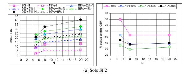
Figura 8.39 - Comparação Entre os Valores de Mini-CBR Não Saturado e Saturado dos Solos Saprolíticos Finos (SF).
