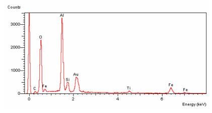
(b) Microanálise x1b - No cristal (provável caulinita) com carbonato e cimento de óxido/hidróxido ferro e/ou titânio
