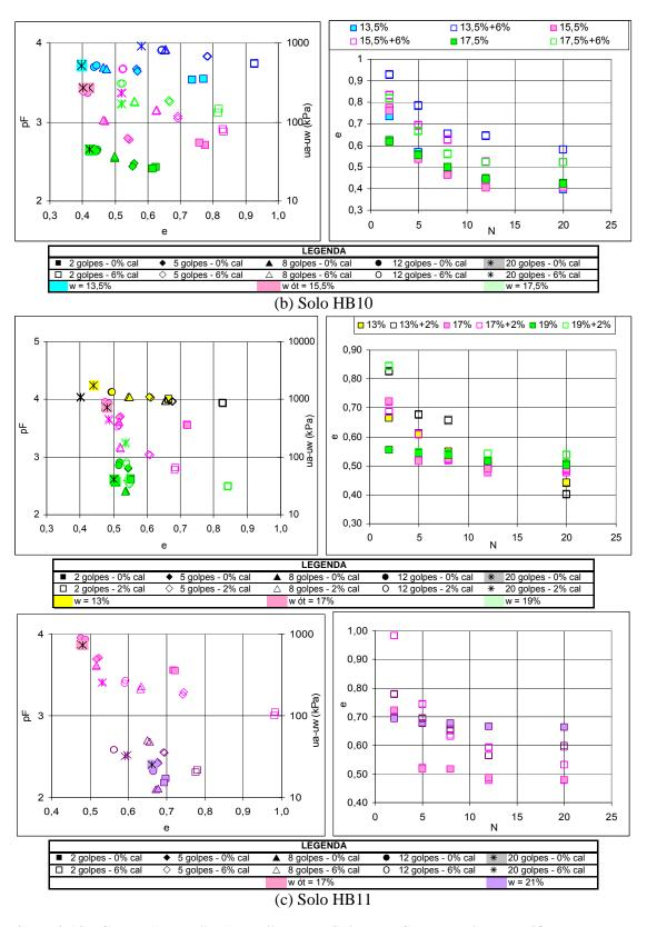
Figura 8.10 - Curvas "pF x e" e "e x N" para os Solos HB Compactados em Diferentes Teores de Umidade e Estabilizados — Continuação.
