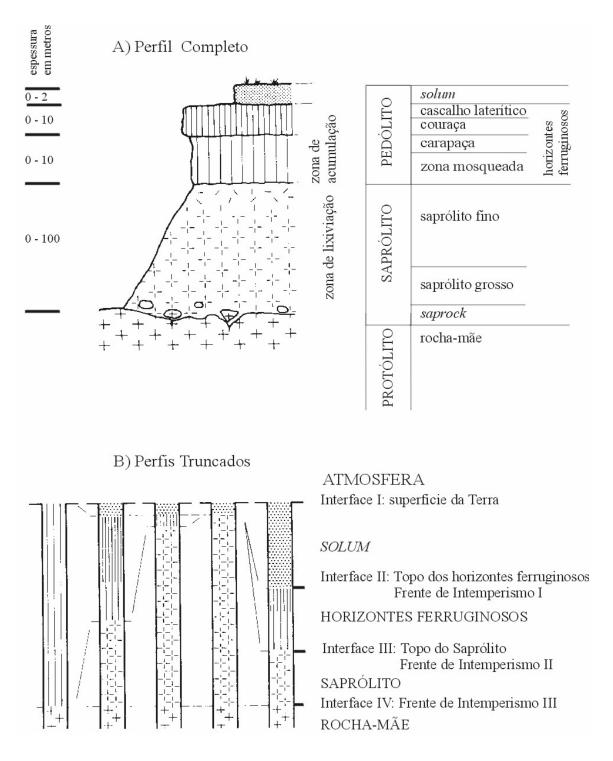
Figura 2.1 - Perfis Lateríticos. A) Esquema do Perfil Completo; B) Diagrama ilustrando Perfis Reduzidos e Truncados (Martins, 2000 *apud* Cardoso, 2002).
