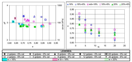
Figura IV.6 - Curvas "pF x e" e "e x N" para o solo SF13 compactado e estabilizado com diferentes teores de umidade e percentuais de cal.
