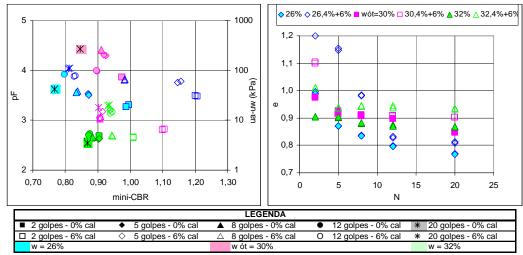
Figura IV.4 - Curvas "pF x e" e "e x N" para o solo HBR2 compactado e estabilizado com diferentes teores de umidade e percentuais de cal – Continuação.
