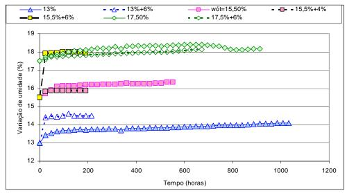
Figura XIII.1 - Evolução da umidade com o tempo para o solo HB10.
