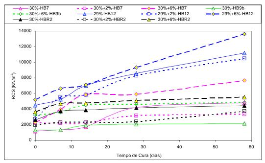
Figura 9.5 – Comparação Entre os Latossolos Compactados a 30% e 29% de Umidade.
