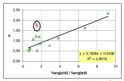
Figura 4.3 - Relação entre Teor de argila Com e Sem Defloculante e Índice de Vazios.
