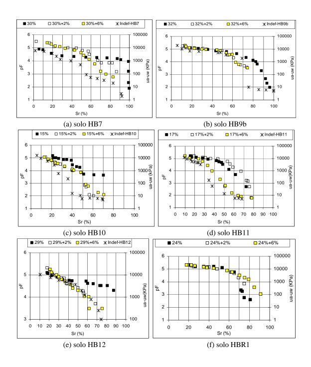
Figura 7.15 - Curvas Características dos Latossolos Estabilizados Quimicamente. (Energia Proctor Normal - PN)
