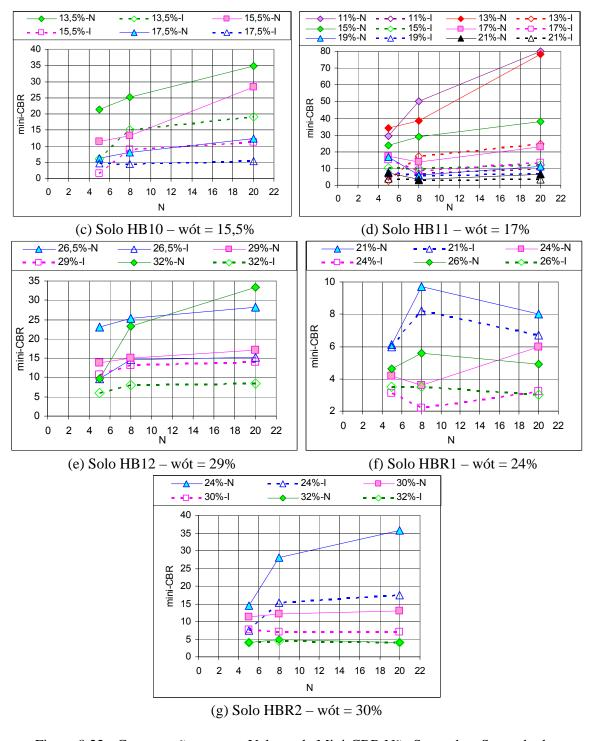
Figura 8.22 - Comparação entre os Valores de Mini-CBR Não Saturado e Saturado dos Latossolos (HB) - Continuação.
