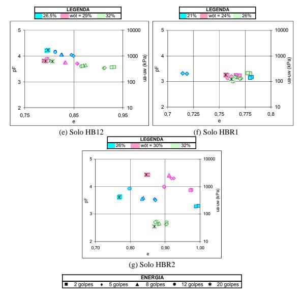
Figura 8.1 - Curvas pF x e para Diferentes Umidades - Solos HB - Continuação.
