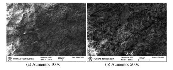
Figura 5.72 - Microscopia de Varredura do Solo SF13 Estabilizado com 6% de Cal Hidratada e Compactado na Energia PN.
