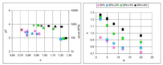
Figura III.1 - Curvas "pF x e" e "e x N" para o solo HB9b compactado no teor de umidade ótima do Proctor Normal e estabilizado com diferentes percentuais de cal.
