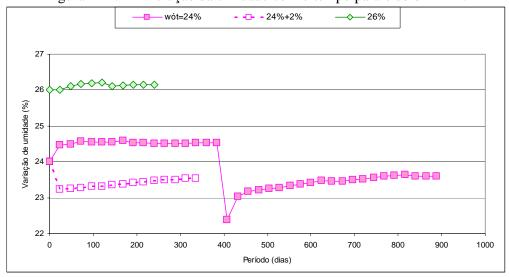
Figura XIII.5 - Evolução da umidade com o tempo para o solo HBR2.
