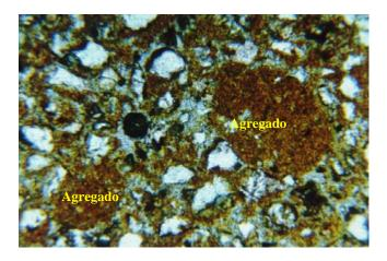
Figura 5.12 – Micoscopia do Solo HB10 em Estado Indeformado, mostrando Agregados no interior do Solo e, Grãos de Quartzo Arredondados a Angulosos Dispersos - Aumento: 90x - Cardoso, (2002).
