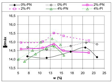
Figura II.6- Mini-compactação do solo ZM3
