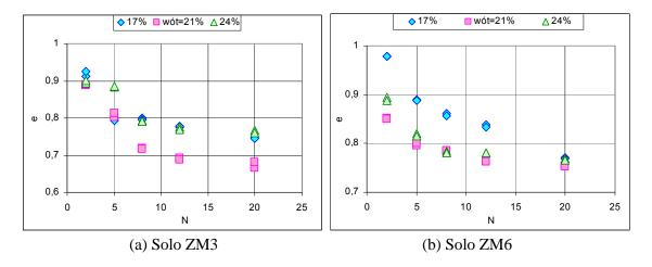
Figura 8.5 - Curvas e x N para Diferentes Umidades - Solos ZM.
