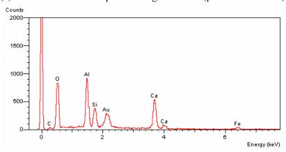
(b) Microanálise x1b. No cristal. Argilomineral (provável caulinita) + carbonato.
