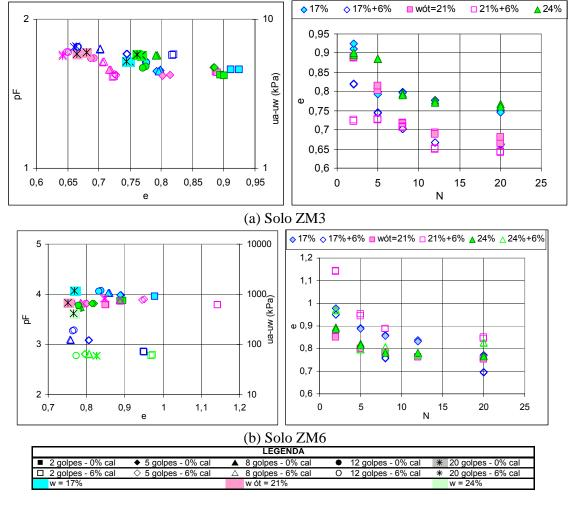
Figura 8.11 - Curvas "pF x e" e "e x N" para os Solos ZM Compactados em Diferentes Teores de Umidade e Estabilizados.
