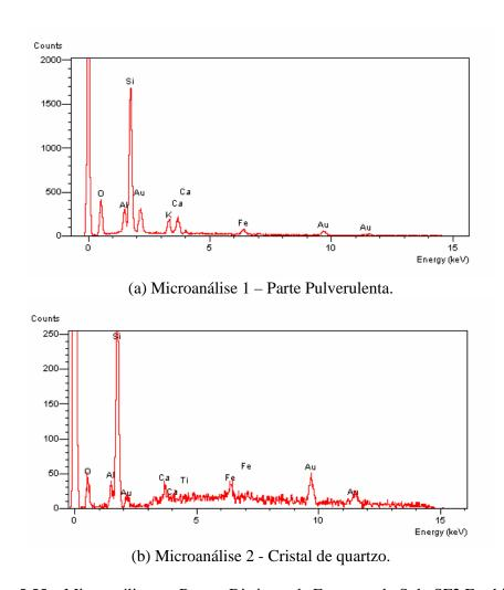
Figura 5.55 – Microanálise em Pontos Distintos da Estrutura do Solo SF2 Estabilizado.
