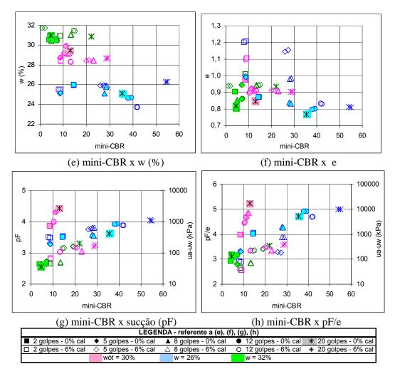
Figura IX.5 - Variação do mini-CBR para o solo HBR2 - Continuação.
