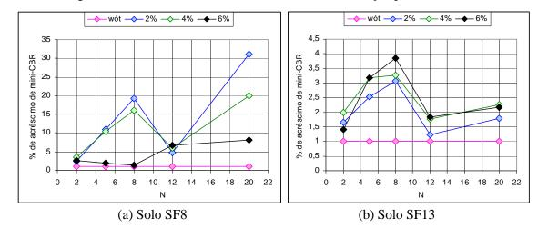
Figura VII.2- Acréscimo de Mini-CBR com a estabilização para os solos SF.
