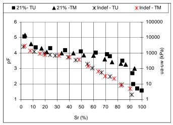
Figura 7.23 - Curvas Características do Solo ZM6 na (TU) e na (TM) para wót de Compactação e Tempo de Equilíbrio de Sucção igual a 15 dias.
