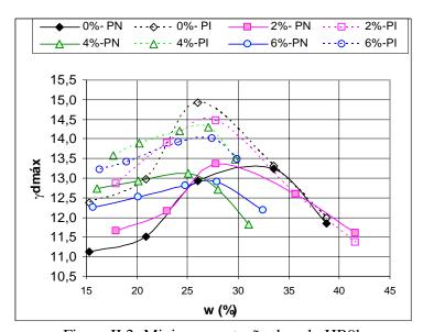
Figura II.2- Mini-compactação do solo HB9b
