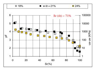
Figura 7.11 - Curvas Características do Solo ZM6 Compactado em Diferentes Umidades.
