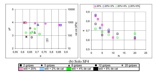
Figura 8.9 - Curvas "pF x e" e "e x N" para os Solos SF Compactados no Teor de Umidade Ótima do Proctor Normal e Estabilizados com Diferentes Percentuais de Cal - Continuação.
