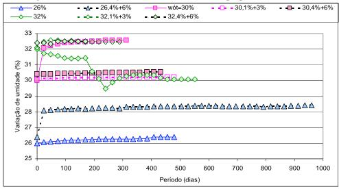
Figura XIII.4 - Evolução da umidade com o tempo para o solo HBR1.
