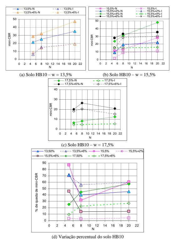
Figura XI.1 - Efeito da saturação na resistência do solo HB10.
