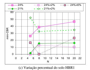
Figura XI.4 - Efeito da saturação na resistência do solo HBR1 - Continuação.
