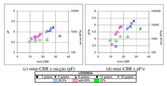
Figura V.2 - Variação do Mini-CBR para o solo HB12 - Continuação.
