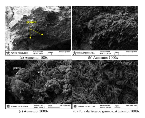
Figura 5.58 - Microscopia de Varredura do Solo SF4 Compactado na Energia PN.
