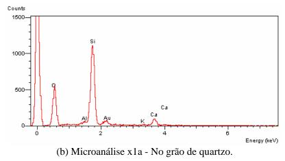
Figura 5.73 - Microanálise do Solo SF13 Estabilizado e Compactado na Energia PN -Continuação.
