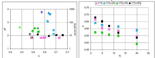
Figura III.5 - Curvas "pF x e" e "e x N" para o solo SF8 compactado no teor de umidade ótima do Proctor Normal e estabilizado com diferentes percentuais de cal.
