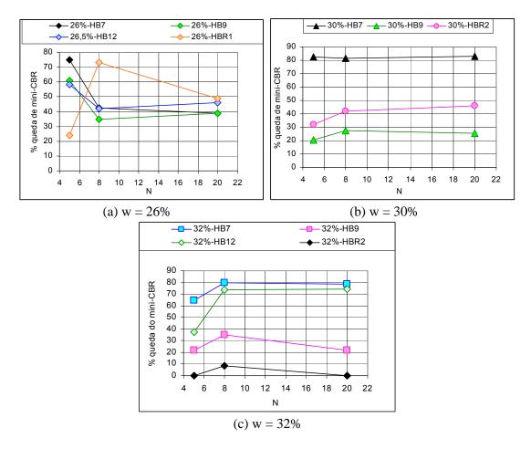
Figura 8.23 - Variação Percentual de Queda da Resistência Com a Imersão.
