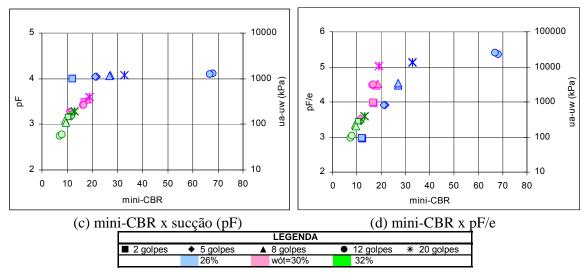
Figura 8.14 - Variação do Mini-CBR para o Solo HB9b - Continuação.
