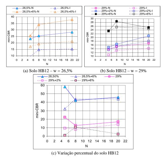
Figura XI.3 - Efeito da saturação na resistência do solo HB12.
