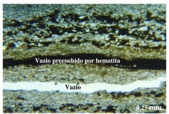
Figura 5.51 - Microfotografias do Solo SF2 em Estado Natural (Indeformado). Cardoso, (2002).
