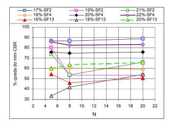
Figura 8.26 - Variação Percentual de Queda da Resistência Com a Imersão - Solos SF.
