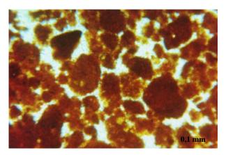
Figura 5.23 – Microscopia do Solo HB12 em Estado Indeformado, mostrando Agregados, na maioria em Blocos, e os Vazios Compactos Simples - Aumento: 90x. Cardoso, (2002).
