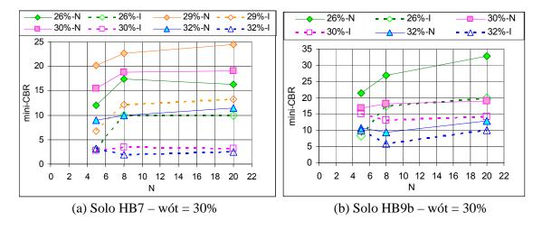
Figura 8.22 - Comparação entre os Valores de Mini-CBR Não Saturado e Saturado dos Latossolos (HB).
