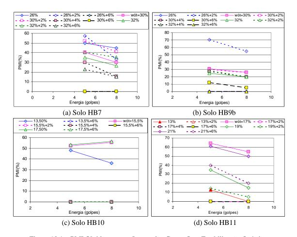
Figura 10.1 – PMI Obtidas para os Latossolos Com e Sem Estabilização Química.
