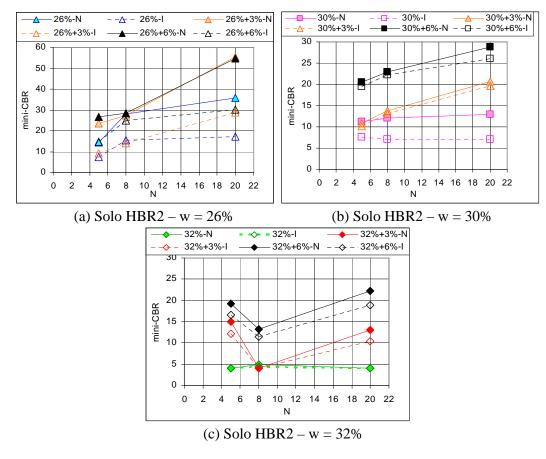
Figura XI.5 - Efeito da saturação na resistência do solo HBR2.
