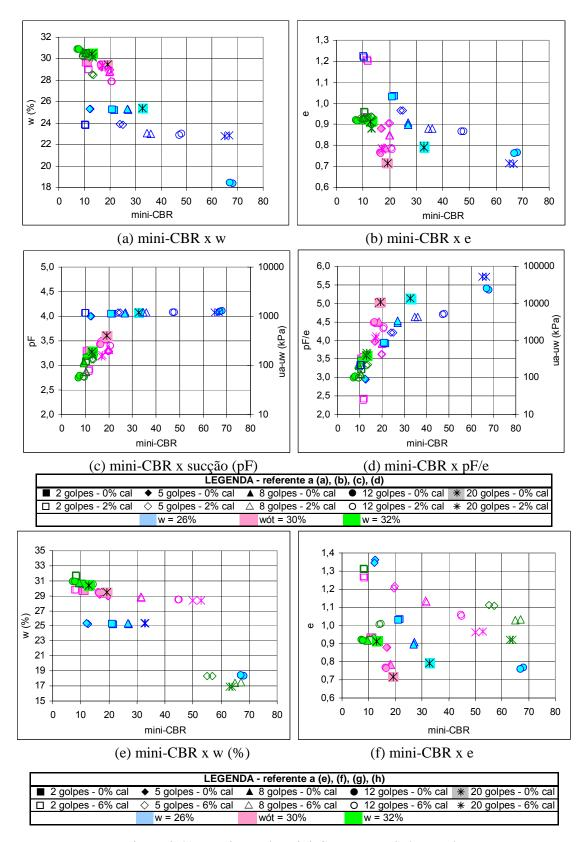
Figura 8.41 - Variação do Mini-CBR para o Solo HB9b.
