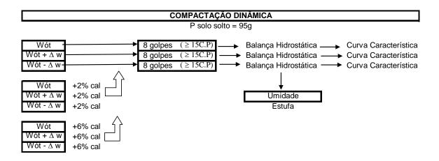
Figura 3.5 – Compactação Dinâmica para Obtenção das Curvas Características.
