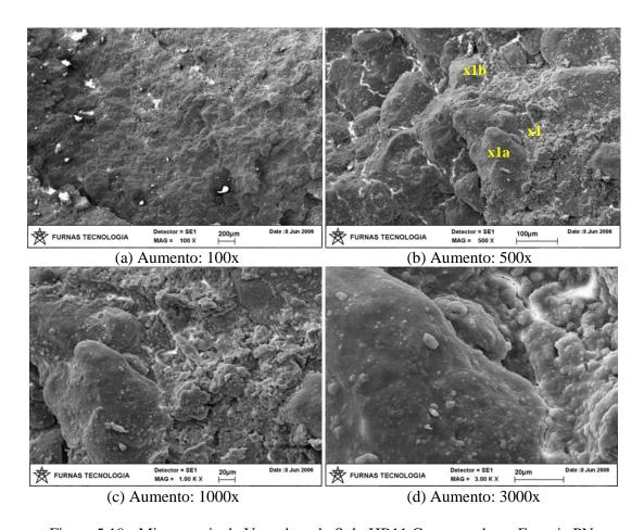
Figura 5.19 - Microscopia de Varredura do Solo HB11 Compactado na Energia PN.
