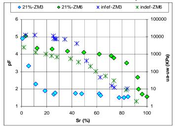
Figura 7.6 - Curvas Características Indeformadas e Compactadas dos Solos da Zona Mosqueada.
