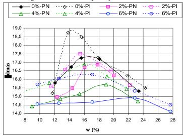
Figura II.4- Mini-compactação do solo HB11
