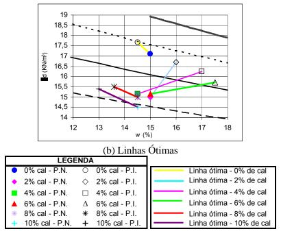
Figura 6.4 – Mini-Compactação do Solo HB10 - Continuação.
