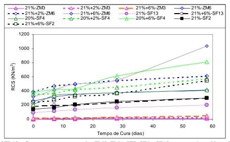
Figura XII.18 – Comparação entre os solos ZM3, ZM6, SF2, SF4 e SF13 compactados a 20% e 21% de umidade.
