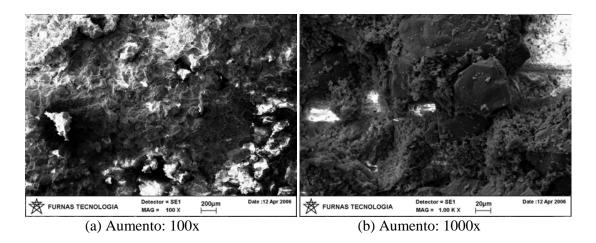
Figura 5.42 - Microscopia de Varredura do Solo ZM3 Estabilizado com 6% de Cal Hidratada e Compactado na Energia PN.
