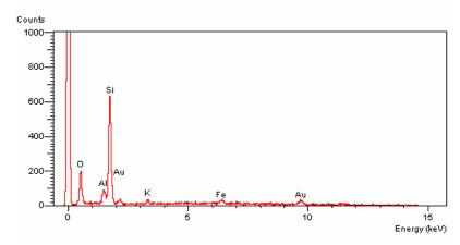
(a) Microanálise x1 - Cristal de quartzo com superfície com argilomineral (provável illita).
