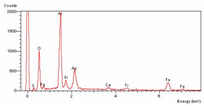
(b) Microanálise x1a - No cristal (provável caulinita) com carbonato e cimento de óxido/hidróxido ferro e/ou titânio.
