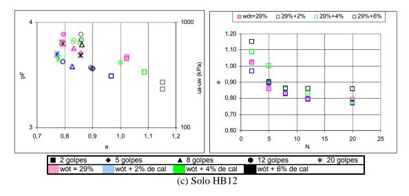
Figura 8.7 - Curvas "pF x e" e "e x N" para os Solos HB Compactados no Teor de Umidade Ótima do Proctor Normal e Estabilizados com Diferentes Percentuais de Cal - Continuação.
