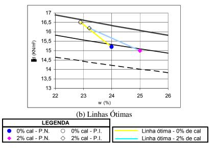
Figura 6.8 – Mini-Compactação do Solo HBR2 - Continuação.
