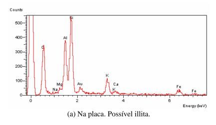
Figura 5.5 – Microanálise no Solo HB7 Estabilizado com 6% de Cal Hidratada e Compactado na Energia PN.
