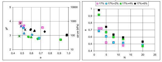
Figura III.2 - Curvas "pF x e" e "e x N" para o solo HB11 compactado no teor de umidade ótima do Proctor Normal e estabilizado com diferentes percentuais de cal.
