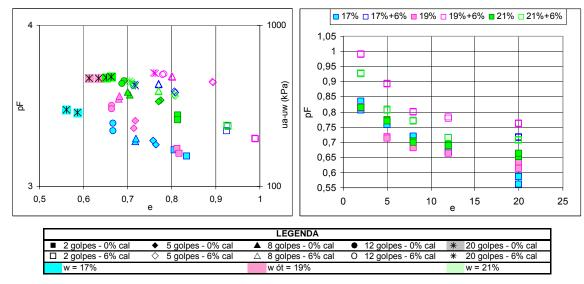
Figura 8.12 - Curvas "pF x e" e "e x N" para o Solo SF2 Compactado em Diferentes Teores de Umidade e Estabilizado.
