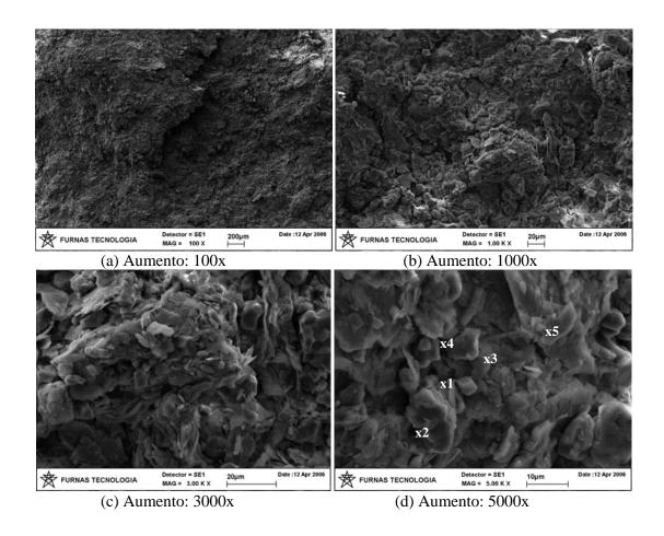
Figura 5.52 - Microscopia de Varredura do Solo SF2 Compactado na Energia PN.
