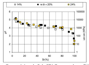
Figura 7.12 - Curvas Características do Solo SF4 Compactado em Diferentes Umidades.
