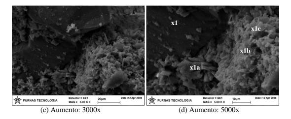
Figura 5.42 - Microscopia de Varredura do Solo ZM3 Estabilizado com 6% de Cal Hidratada e Compactado na Energia PN – Continuação.
