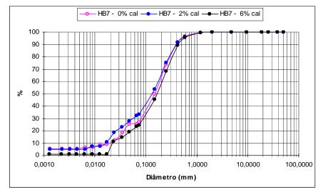
Figura 5.6 – Curvas Granulométricas obtidas para o Solo HB7.
