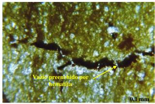
Figura 5.45 - Microscopia do Solo ZM6 obtida para Amostra Natural (Indeformada), mostrando Vazio preenchido por Hematita. Aumento: 90x.
