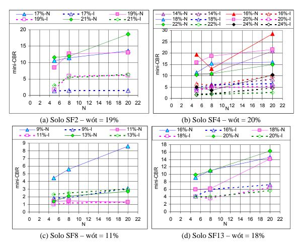
Figura 8.25 - Comparação entre os Valores de Mini-CBR Não Saturado e Saturado dos Solos Saprolíticos Finos (SF).
