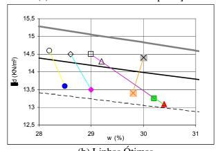
(b) Linhas Ótimas **LEGENDA** Linha ótima - 0% de cal 0% cal - P.N. 0% cal - P.I. 2% cal - P.N. 2% cal - P.I. Linha ótima - 2% de cal x 3% cal - P.I. 3% cal - P.N. Linha ótima - 3% de cal 4% cal - P.N. ☐ 4% cal - P.I. Linha ótima - 4% de cal 6% cal - P.N. 6% cal - P.I. Linha ótima - 6% de cal
