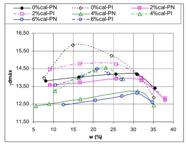
Figura II.1- Mini-compactação do solo HB7
