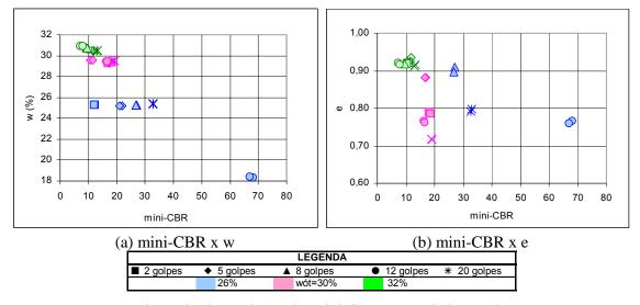
Figura 8.14 - Variação do Mini-CBR para o Solo HB9b.
