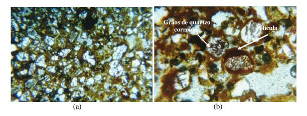
Figura 5.18 - Microscopia do Solo HB11 obtida para Amostra Natural (Indeformada). (a) Fotomicrografia mostrando o predomínio dos grãos de quartzo. Aumento: 40x. (b) Grãos de quartzo fortemente corroídos. Aumento: 90x. Cardoso, (2002).
