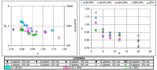
Figura IV.2 - Curvas "pF x e" e "e x N" para o solo HB12 compactado e estabilizado com diferentes teores de umidade e percentuais de cal.
