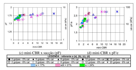
Figura IX.6 - Variação do mini-CBR para o solo ZM3 - Continuação.
