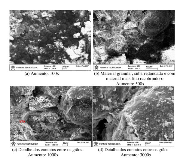
Figura 5.66 - Microscopia de Varredura do Solo SF8 Estabilizado com 6% de Cal Hidratada e Compactado na Energia PN.
