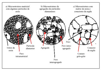
Figura 2.11. Tipos de estrutura do solo (Alonso et al, 1987).
