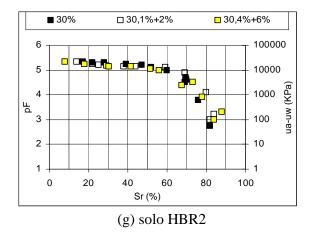
Figura 7.15 - Curvas Características dos Latossolos Estabilizados Quimicamente - Continuação. (Energia Proctor Normal - PN).
