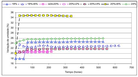
Figura 11.6 – Curva de Infiltrabilidade do Solo SF4 Natural e Estabilizado.
