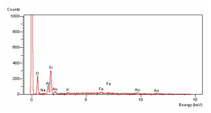
(b) Microanálise x2 - Cristal de quartzo com superfície com argilomineral (provável illita).
