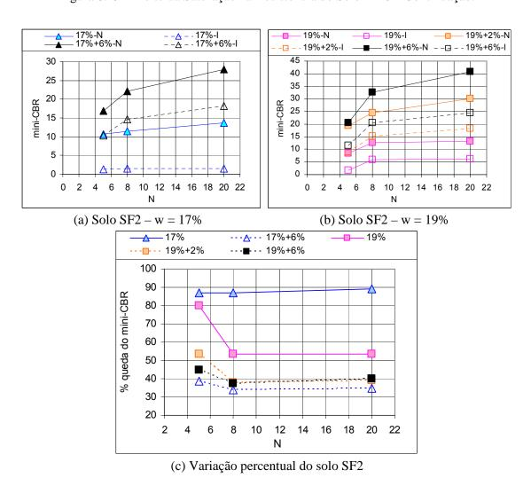
Figura 8.50 - Efeito da Saturação na Resistência do Solo SF2.
