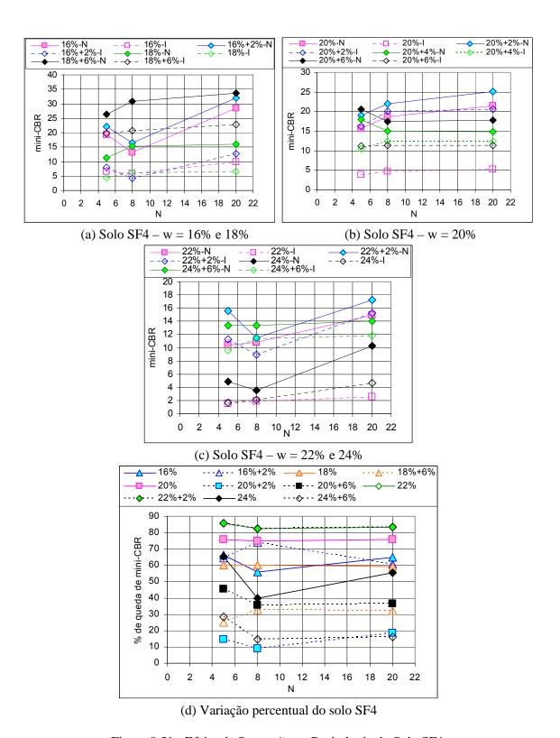
Figura 8.51 - Efeito da Saturação na Resistência do Solo SF4.
