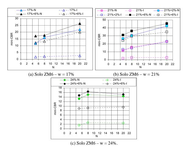
Figura 8.49 - Efeito da Saturação na Resistência do Solo ZM6.
