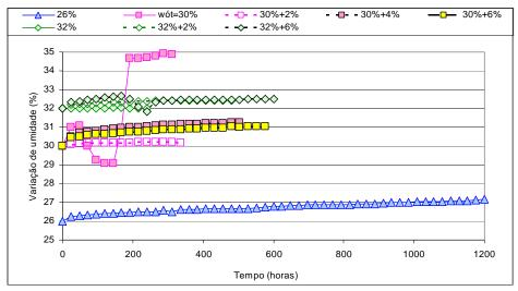
Figura 11.1 – Curva de Infiltrabilidade do Solo HB7 Natural e Estabilizado.
