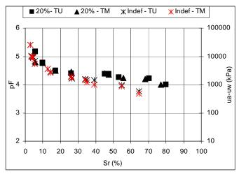
Figura 7.24 - Curvas Características do Solo SF4 na (TU) e na (TM) para wót de Compactação e Tempo de Equilíbrio de Sucção igual a 15 dias.
