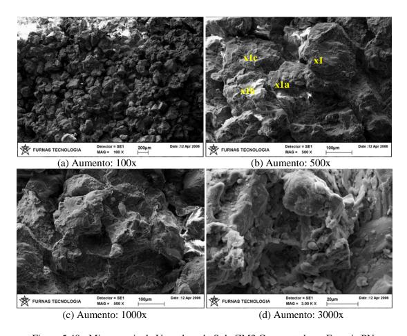
Figura 5.40 - Microscopia de Varredura do Solo ZM3 Compactado na Energia PN.
