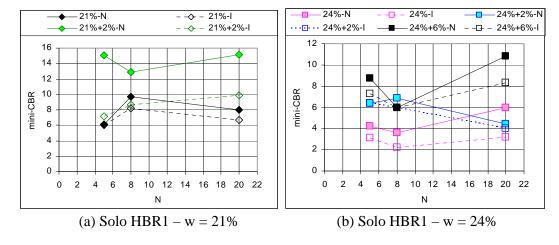
Figura XI.4 - Efeito da saturação na resistência do solo HBR1.
