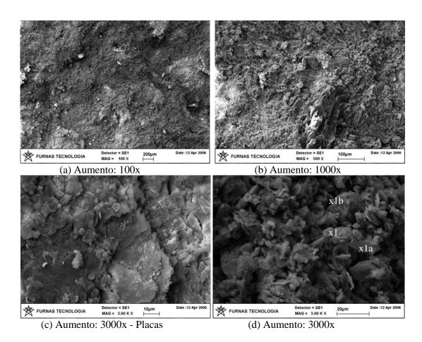
Figura 5.54 - Microscopia de Varredura do Solo SF2 Estabilizado com 6% de Cal Hidratada e Compactado na Energia PN.
