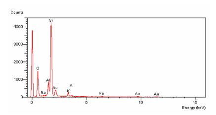
(a) Microanálise x1- No grumo. Cristal de quartzo + argilomineral (provável illita).
