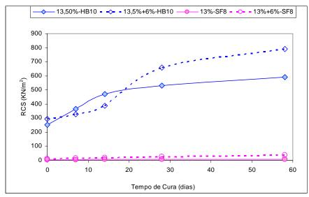
Figura XII.12 – Comparação entre os solos HB10 e SF8 compactados a 13% de umidade.
