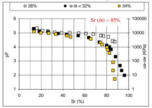
Figura 7.9 - Curvas Características do Solo HB9b Compactado em Diferentes Umidades.
