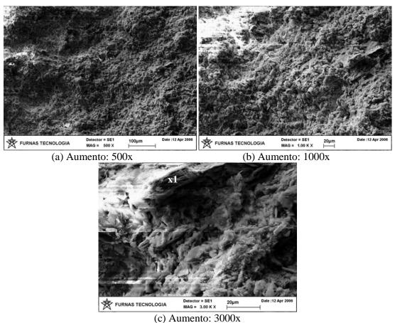
Figura 5.48 - Microscopia de Varredura do Solo ZM6 Estabilizado com 6% de Cal Hidratada e Compactado na Energia PN.
