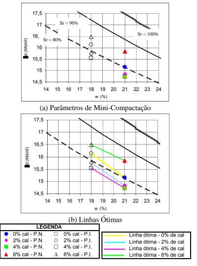
Figura 6.10 – Mini-Compactação do Solo ZM6.
