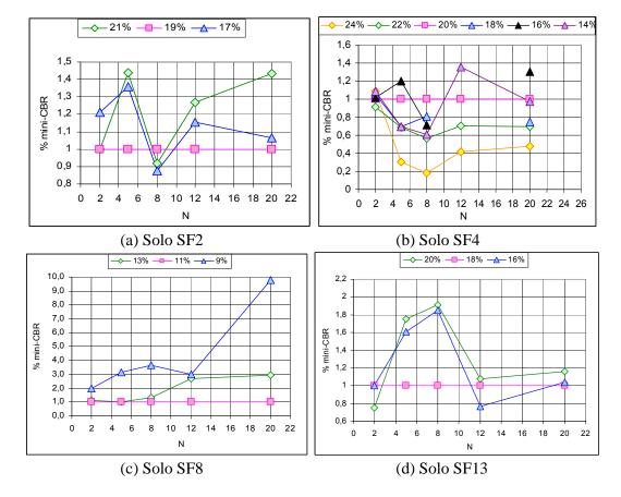
Figura 8.21 - Variação Percentual do Mini-CBR, em Relação aos Valores obtidos para a Compactação na wót – Solos SF.
