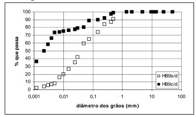
Figura I.2 – Curvas Granulométricas do solo HB9b.
