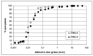
Figura I.10 – Curvas Granulométricas do solo ZM6.
