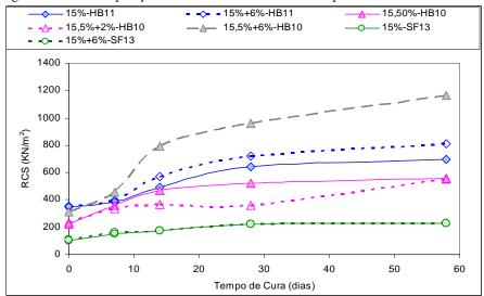
Figura XII.13 – Comparação entre os solos HB10, HB11 e SF13 compactados a 15% de umidade.
