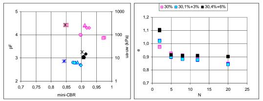
Figura III.4 - Curvas "pF x e" e "e x N" para o solo HBR2 compactado no teor de umidade ótima do Proctor Normal e estabilizado com diferentes percentuais de cal.
