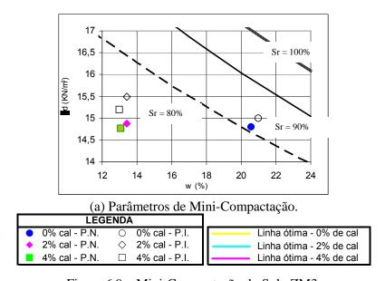
Figura 6.9 – Mini-Compactação do Solo ZM3.
