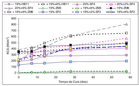
Figura XII.15 – Comparação entre os solos HB11, ZM3, ZM6, SF2 e SF4 compactados a 19% e 20% de umidade.
