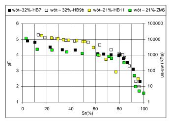
Figura 7.13 - Curvas Características de Amostras Compactadas para Solos HB e ZM.
