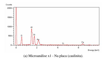
Figura 5.9 - Microanálise do Solo HB9b Compactado na Energia PN.
