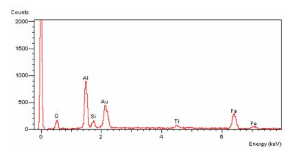
(a) Microanálise x1 - No cristal (provável caulinita) com carbonato e cimento de óxido/hidróxido ferro e/ou titânio.
