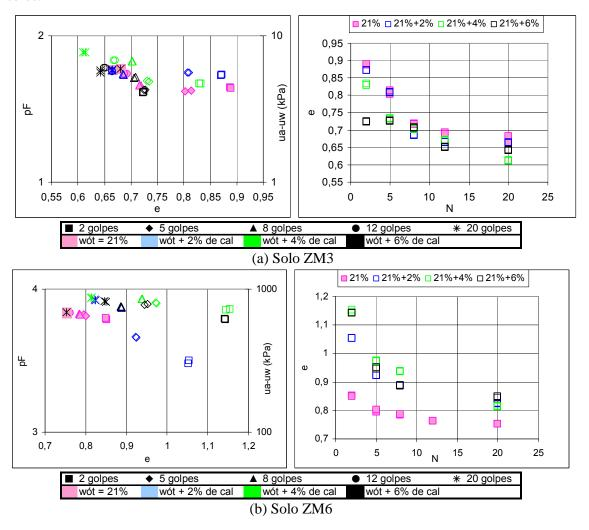
Figura 8.8 - Curvas "pF x e" e "e x N" para os Solos ZM Compactados no Teor de Umidade Ótima do Proctor Normal e Estabilizados com Diferentes Percentuais de Cal.
