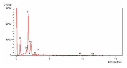
(a) Microanálise x1 - No grumo (quartzo com provável contaminação de ilita).Figura 5.47 - Microanálise do Solo ZM6 Compactado na Energia PN.
