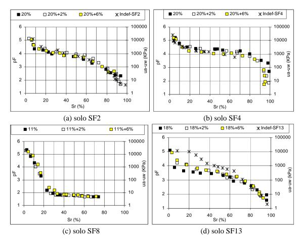
Figura 7.17 - Curvas Características dos Solos Saprolíticos Estabilizados. (Energia Proctor Normal - PN)
