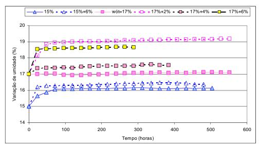
Figura XIII.2 - Evolução da umidade com o tempo para o solo HB11.
