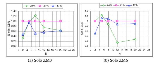
Figura 8.18 - Variação Percentual do Mini-CBR em Relação aos Valores obtidos para o Teor de Umidade de Compactação Ótimo – Solos ZM.
