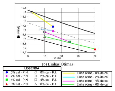
Figura 6.5 – Mini-Compactação do Solo HB11 - Continuação.
