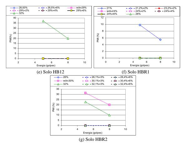
Figura 10.1 – PMI Obtidas para os Latossolos Com e Sem Estabilização Química - Continuação.
