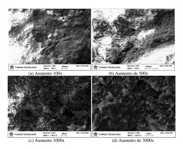
Figura 5.4 - Microscopia de Varredura do Solo HB7 Estabilizado com 6% de Cal Hidratada e Compactado na Energia PN.
