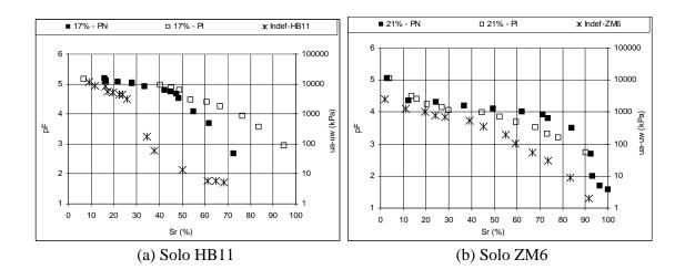
Figura 7.14 - Curvas Características Compactadas na Energia Proctor Intermediária (PI).
