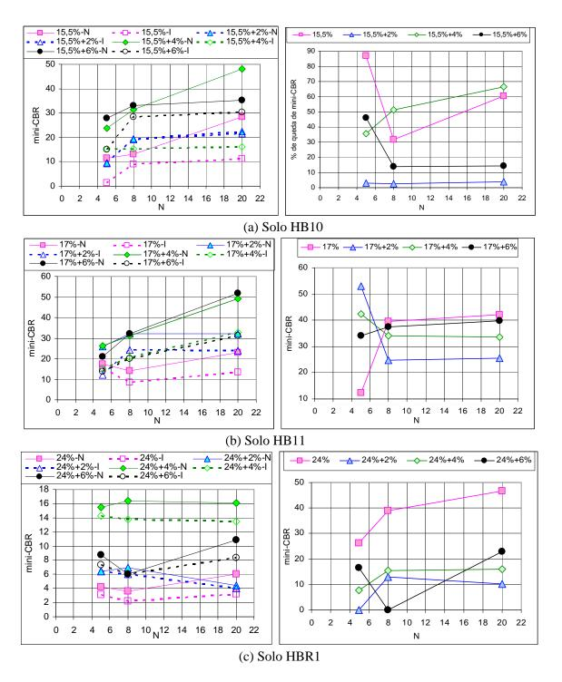
Figura VIII.1- Decréscimo de mini-CBR com a estabilização para os solos HB.
