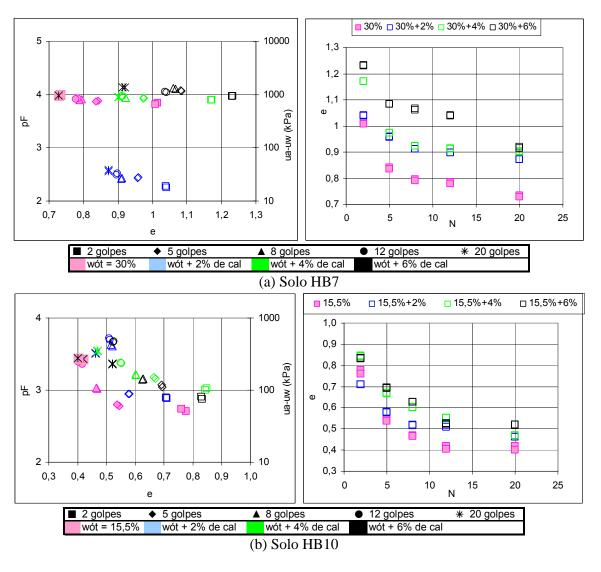
Figura 8.7 - Curvas "pF x e" e "e x N" para os Solos HB Compactados no Teor de Umidade Ótima do Proctor Normal e Estabilizados com Diferentes Percentuais de Cal.
