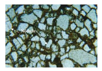
Figura 5.39 - Microfotografias do Solo ZM3 em Estado Natural (Indeformado) mostrando Grãos de Quartzo Dispersos e, Vazios Compactos, onde alguns são preenchidos por Nódulos de Hematita. Aumento: 90x.
