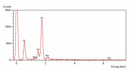
(a) Microanálise x1 – Cristal de quartzo com superfície com argilomineral (provável caulinita).
