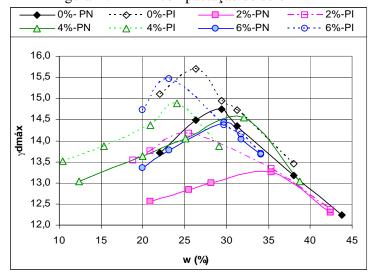
Figura II.5- Mini-compactação do solo HB12
