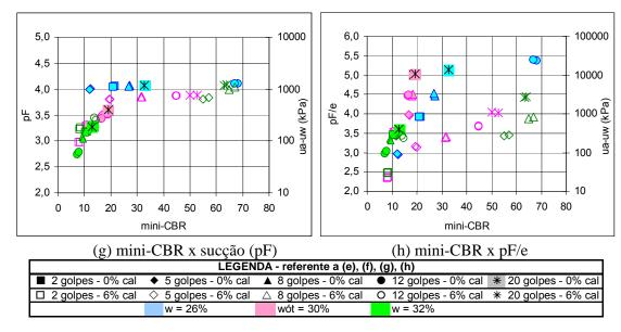
Figura 8.41 - Variação do Mini-CBR para o Solo HB9b - Continuação.
