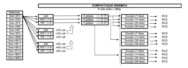
Figura 3.11 – Obtenção das Resistências à Compressão Simples dos Solos (RCS).
