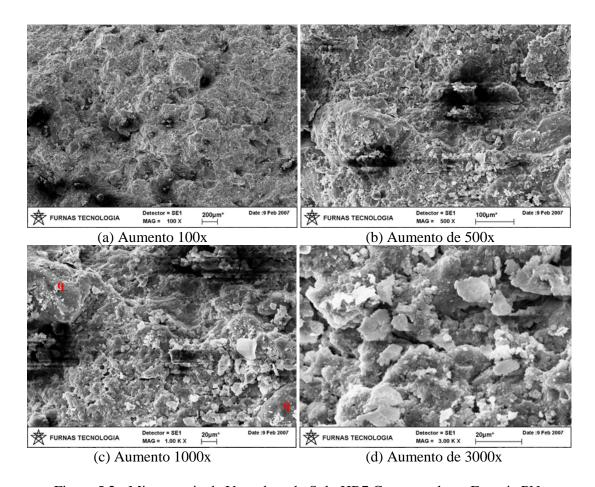
Figura 5.2 - Microscopia de Varredura do Solo HB7 Compactado na Energia PN.
