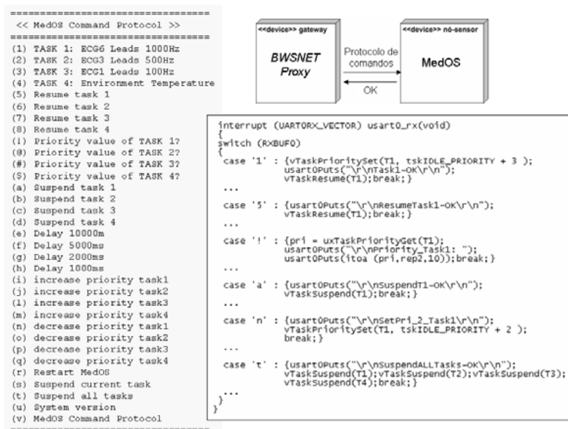
Figura 4.26 - Uma instância do interpretador de comandos para um sensor de ECG.
