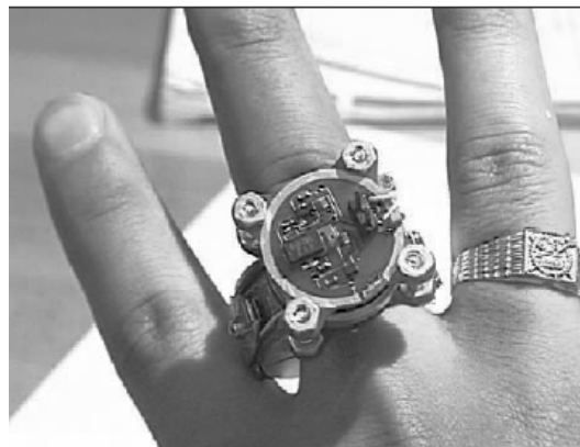
Figura 2.7 – Um sensor vestível em forma de anel (ASADA et al. , 2003).
