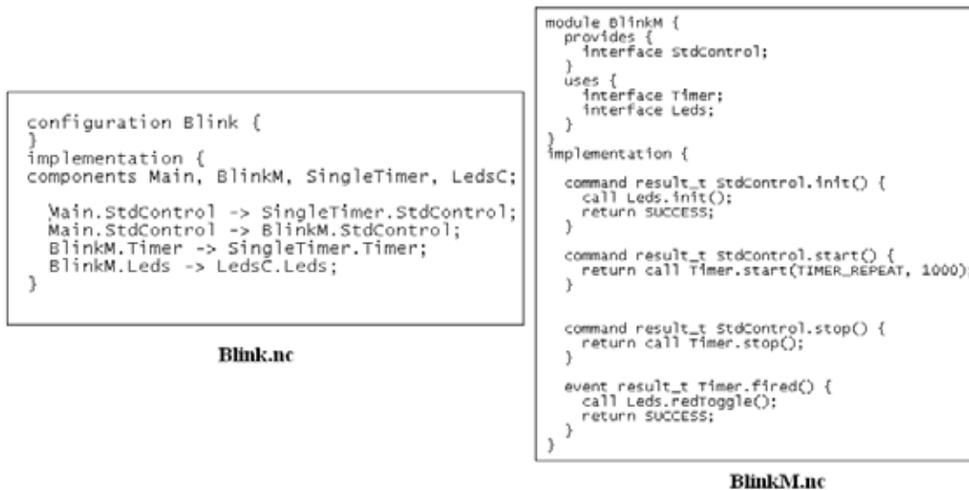
Figura 2.14 – Exemplo de aplicação desenvolvida utilizando NesC e componentes do TinyOS.
