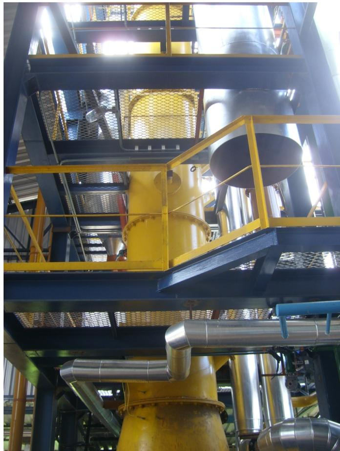
Figura 1.1 – Reator do sistema de gaseificação de leito fluidizado circulante. GASLIN.
