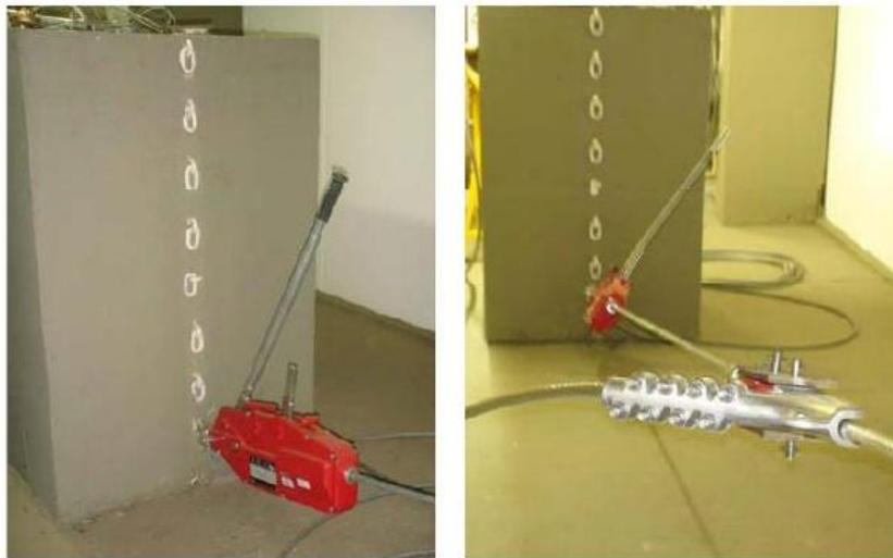
Figura 4.25-Talha de alavanca ancorada ao bloco de fixação 1 (Fadel, 2010).
