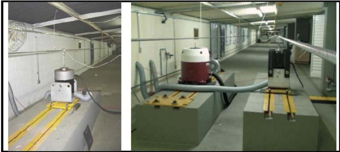
Figura 4.28- Bloco fixo com trilho para deslocamento do *shaker* (Fadel, 2010).
