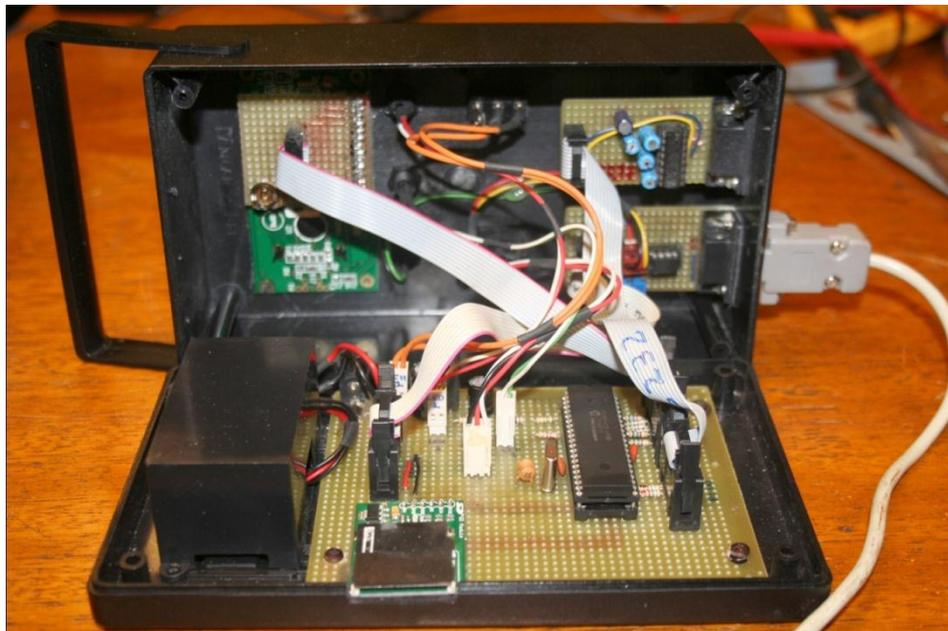
Figura 4.23 - Módulo de condicionamento e aquisição de dados, vista interna.
