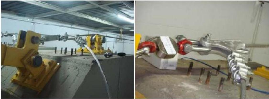
Figura 4.26 a) Fixação do cabo através do grampo de ancoragem passante no bloco fixo 3, b) Detalhe do grampo de ancoragem passante e a célula de carga (Fadel, 2010).
