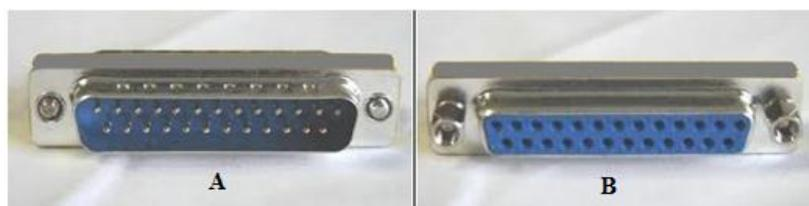
Figura 2.17 – (A) conector macho DB25. (B) direita o conector fêmea
