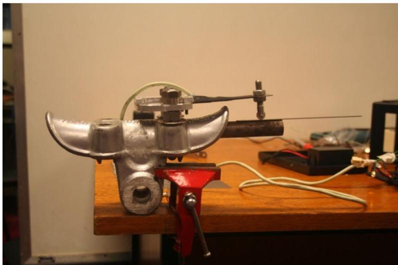
Figura 5.2 – Procedimento de Calibração Estática.
