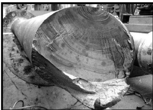
(a) Superfície de falha de um eixo.
