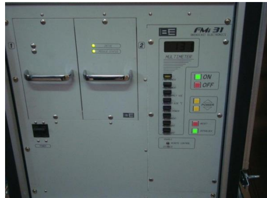
Figura 48 – Detalhe do excitador (esq.) e dos amplificadores (dir.).
