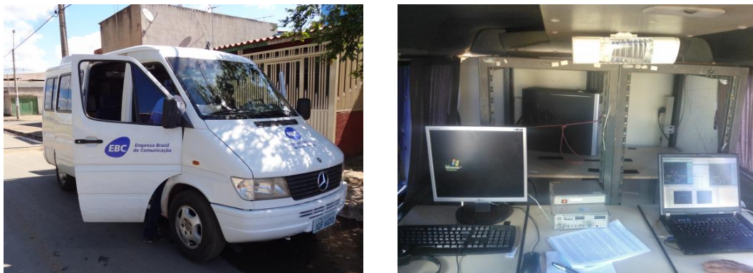
Figura 20 – Viatura móvel adaptada com detalhes dos equipamentos de medição.
