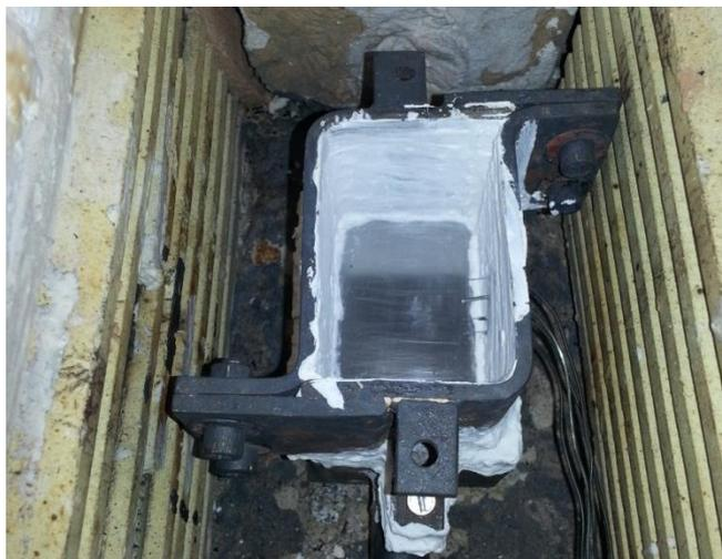
Figura 4.16 - Lingoteira montada e pronta para realizar um ensaio
