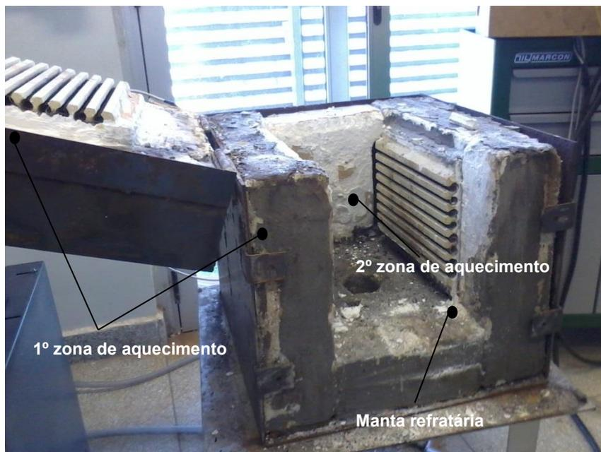
Figura 4.8 - Forno fabricado para experimento com 2 zonas de aquecimento
