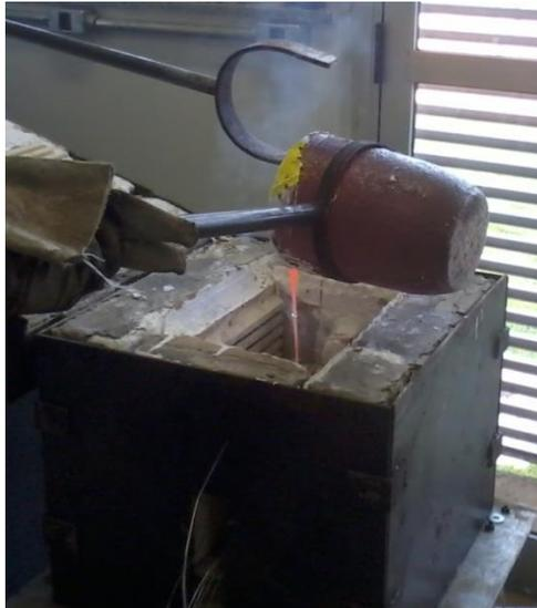
Figura 4.15 - Vazando o metal líquido dentro da lingoteira
