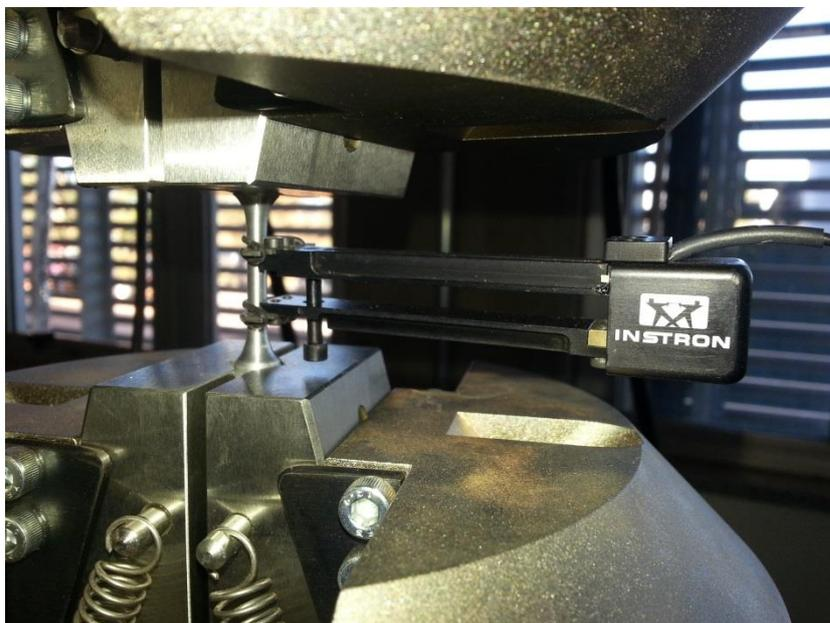
Figura 4.23 - Realização do ensaio de tração
