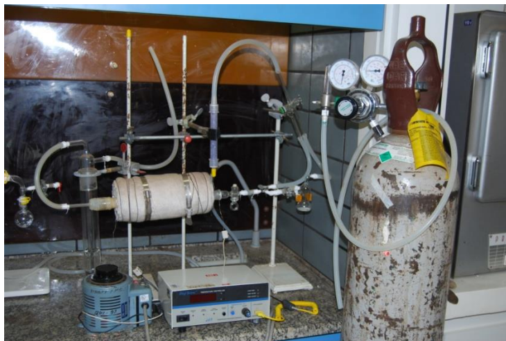
Figura 15: Sistema de adsorção de piridina em fase gasosa.
