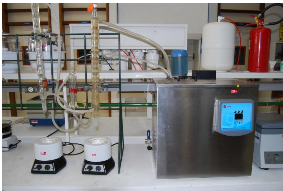
Figura 18: Sistema de refluxo utilizado para as reações de esterificação.
