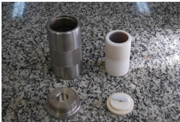
Figura 16: Copo de teflon e reator de aço inoxidável utilizado para as reações de isomerização.
