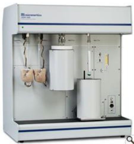
Figura 14: Equipamento de análise textural da Micromeritics, modelo ASAP 2020. 59
