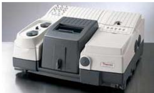
Figura 10: Espectrômetro de infravermelho da Thermo Scientific, modelo Nicolet 6700. 55
