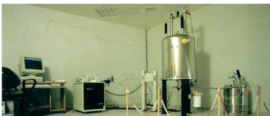
Figura 13: Equipamento de RMN da Varian, modelo Mercury Plus. 58
