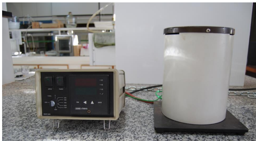
Figura 17: Sistema de controle de temperatura e agitação da Berghof (modelo HR-200).
