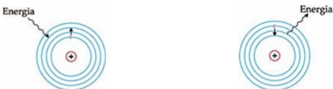
**Figura:** Esquema da absorção e liberação de energia nos níveis.
