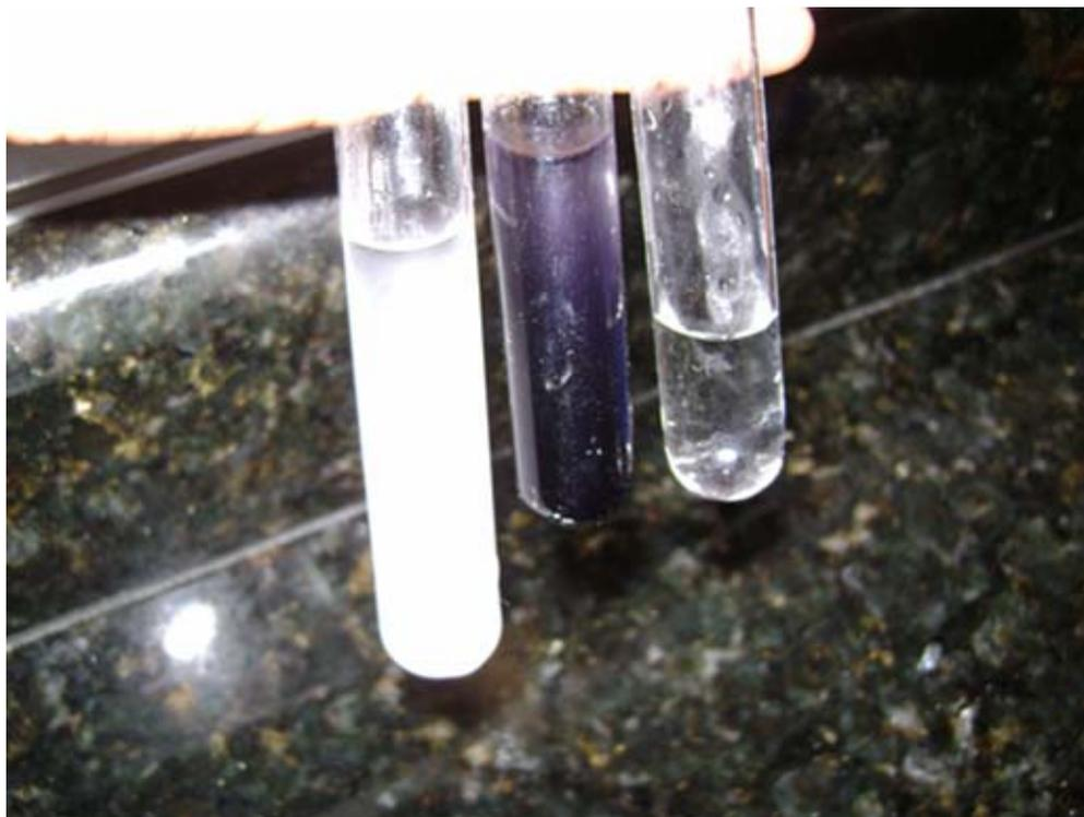
**Figura:** Experimento de Identificação do cloro na água.
