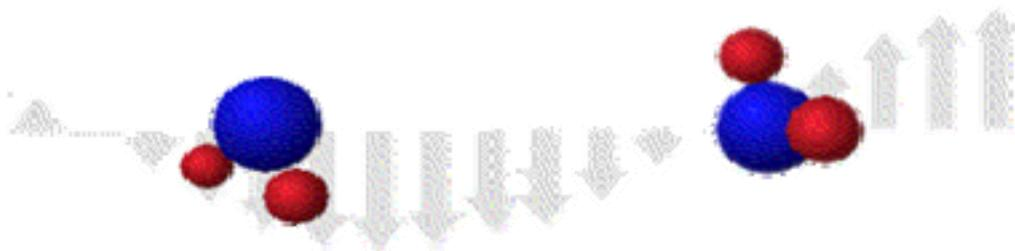
**Figura** - Esquema de moléculas de água se alinhando à onda eletromagnética.
