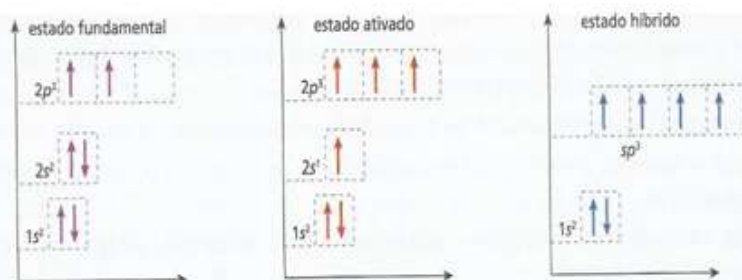
Figura 1-8: Diagramas representando a distribuição dos elétrons do átomo de carbono nos subníveis, nos estados fundamental, ativado e híbrido sp^3 .
