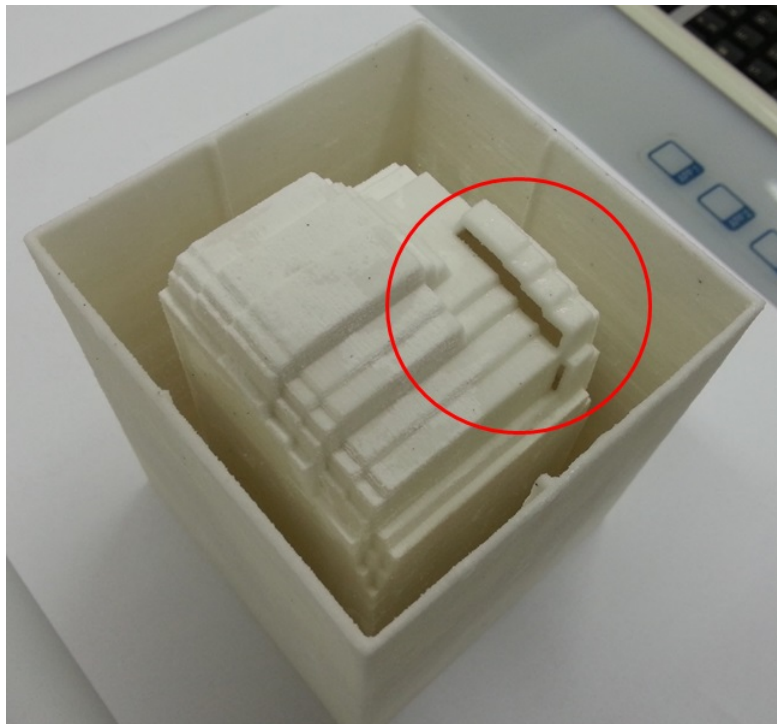
Figura 4.12. Erro no molde devido à falha no arquivo STL. Em destaque uma região no molde contendo um buraco.
