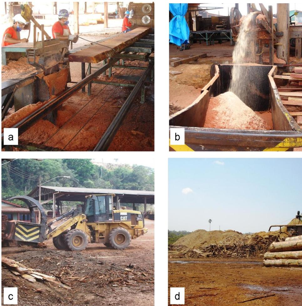
Figura 4.4 – Ciclo da serragem: a) Geração da serragem; b) Caixa de serragem; c) Descarregamento da caixa; d) Monte de serragem.
