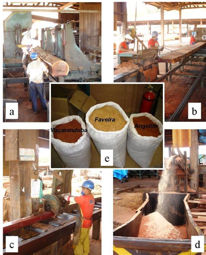
Figura 2.9 – Sequência de atividades na serraria: a) serra fita vertical, b) Serra refileadeira, c) serra destopadeira, d) caixa de serragem e e) amostras de serragem.
