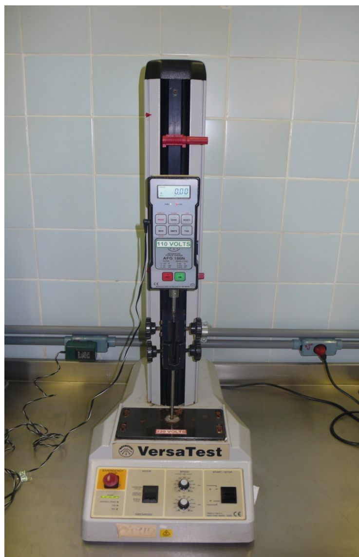
FIGURA 20 – APARELHO DE ENSAIO VERTICAL (VERSA TEST) ACOPLADO AO DINAMÔMETRO DIGITAL
