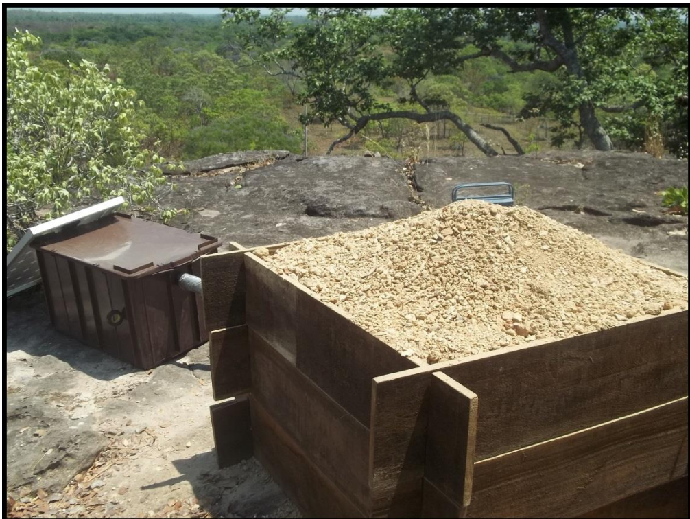
Figura 2.4: Sismômetro enterrado. Estação SAMA, localizada em Santa Maria do Tocantins-TO.
