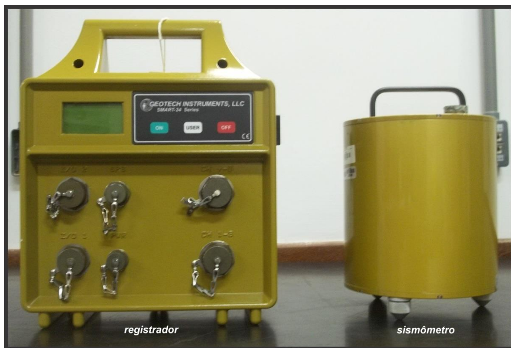
Figura 2.1: Registrador Smart-24 e sismômetro de banda larga, modelo KS2000 da marca Geotech.
