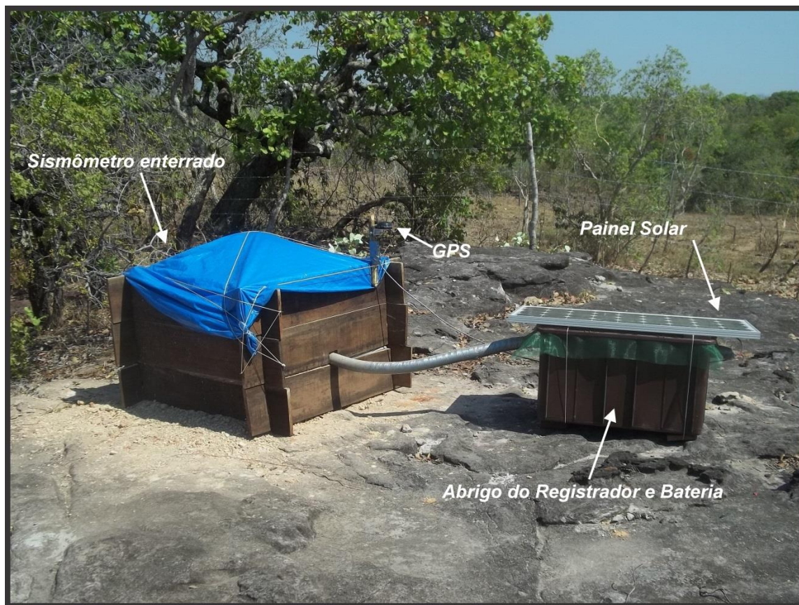
Figura 2.5: Estação SAMA, localizada em Santa Maria do Tocantins – TO.
