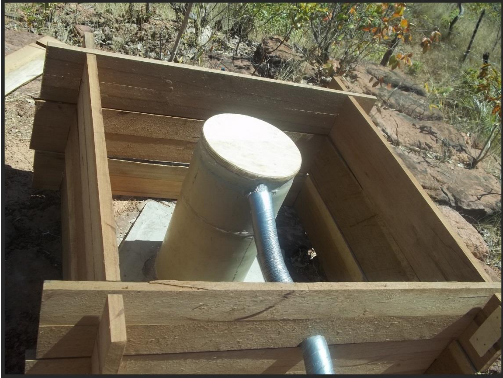
Figura 2.3: Sismômetro montado sobre uma base de cimento e isolado de influências externas. Estação MATE, localizada em Mateiros – TO.
