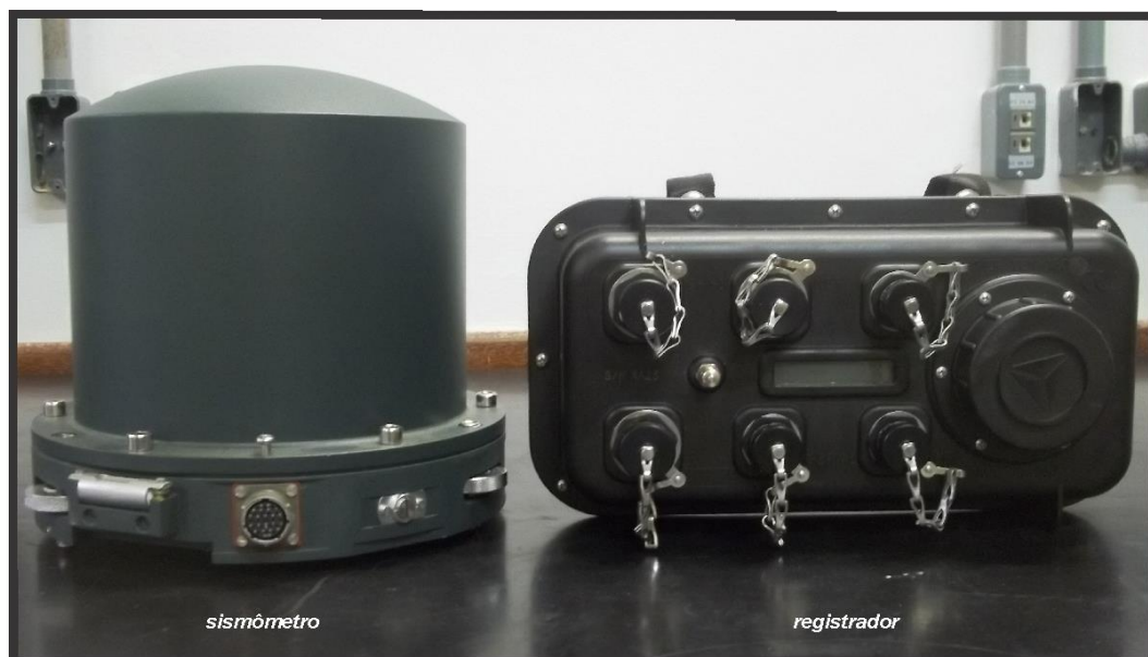
Figura 2.2: Sismômetro de banda larga modelo 151 e registrador modelo 130-01 da marca Reftek.
