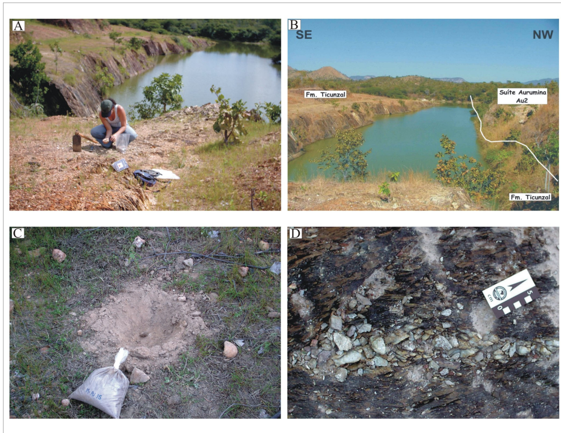
Figura 5.1 – Aspectos do processo de amostragem durante a segunda etapa de campo. A) Amostragem de zonas silicificadas na porção frontal do antigo veio lavrado, onde hoje se encontra o lago da antiga cava. B) Localização da região de coleta das amostras de solo de rochas da Formação Ticunzal e Suíte Aurumina. C) Exemplo de amostragem de solo na área do biotita-muscovita granito, ponto M-Au35. D) Porção silicificada do ponto M-Au23 em meio ao xisto grafitoso, ponto localizado na região frontal do veio e que apresentou valores elevados de ouro.
