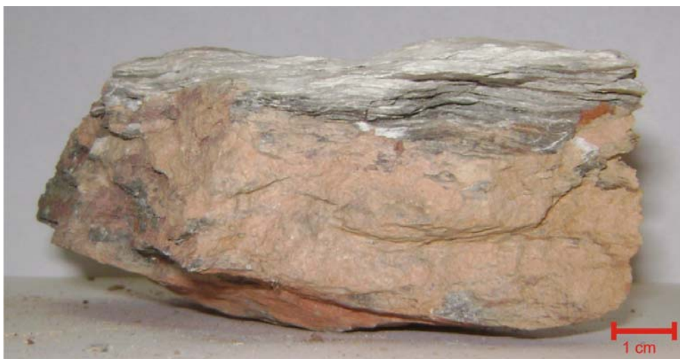
Figura 4.1 – Filito (LF-DF-009) cinza claro com lamelas brancas e alteração rosa.
