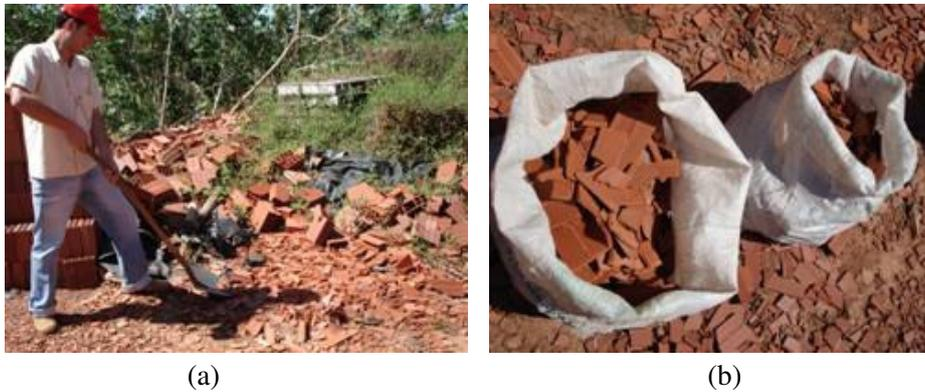
Figura 4.5 - Coleta do resíduo de blocos na indústria cerâmica selecionada. (a) Coleta segundo a ABNT NBR1007:2004; (b) Acondicionamento do resíduo
