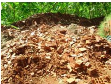
Figura 3.11 – Resíduos de blocos cerâmicos depositados na industria cerâmica selecionada
