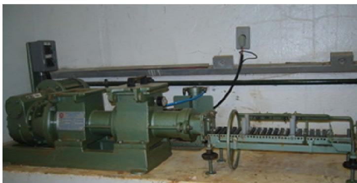
Figura 4.8 – Imagem da extrusora utilizada para a moldagem dos corpos de prova
