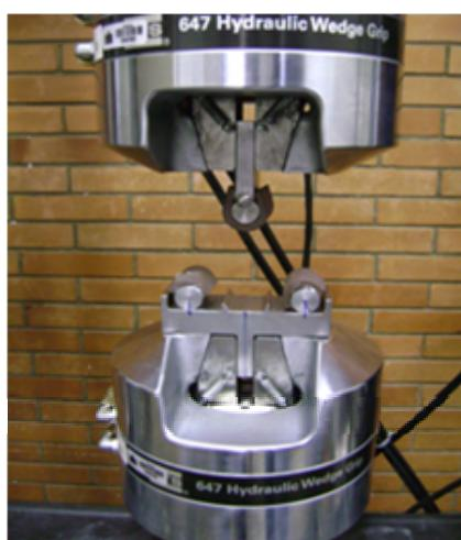
Figura 4.12 – Máquina universal utilizada para o ensaio de resistência mecânica à flexão. Detalhe das barras cilíndricas, central e de apoio, recobertas de borracha.
