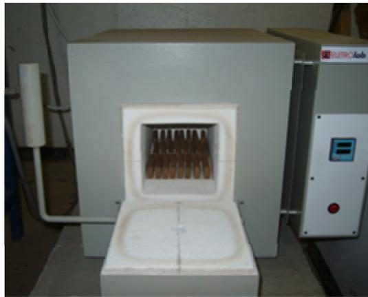
Figura 4.10 – Disposição dos corpos de prova na mufla
