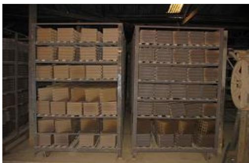
Figura 3.7 - Heterogeneidade na secagem do bloco, devido a falta de controle de temperatura, umidade relativa do ar e tempo na secagem (SPOSTO, MORAIS E PEREIRA, 2006)
