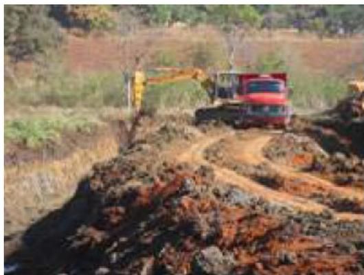
Figura 3.2 – Extração de argila para produção de blocos cerâmicos (Fonte: MORAIS, 2006)
