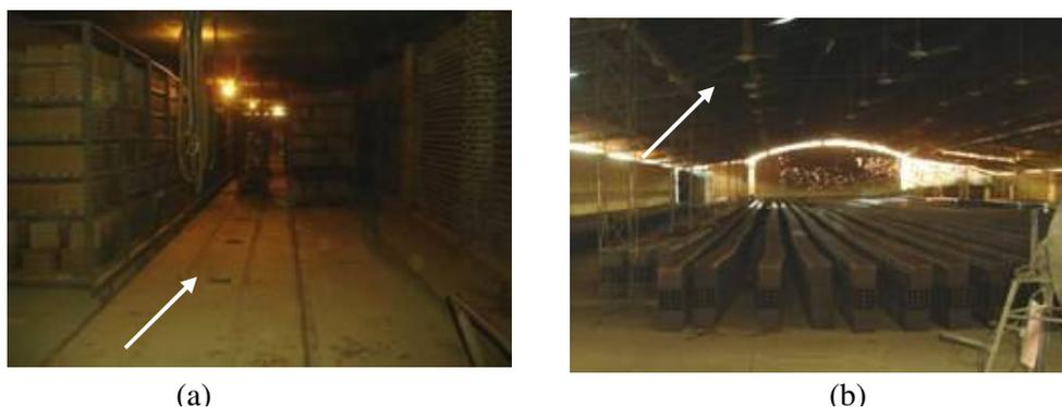
Figura 3.8. – Secagem artificial em blocos cerâmicos. a) secagem por meio de gases quentes e b) secagem por meio de ventiladores de teto
