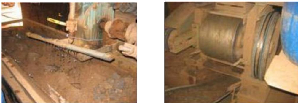
Figura 3.4 – Preparo da argila para fabricação de blocos cerâmicos. a) homogeneização; b) laminação.(MORAIS, 2006)
